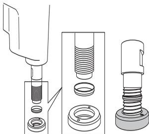
**OBS!** Friktionsringen används för att förhindra skador på axeln och växellådan vid lossning av borrar.
