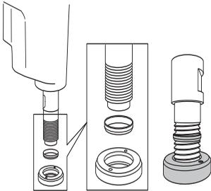
**BEMÆRK!** Friktionsringen bruges til at forhindre skader på akslen og gearkassen, når boret afmonteres.
