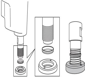
**MERKNAD!** Friksjonsringen brukes til å forhindre skade på akselen og girkassen når borkronen demonteres.
