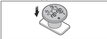
3. Coloque el equipo de corte en la posición de transporte. Consulte *Para colocar el equipo de corte en la posición de transporte o posición de corte en la página 44*.
