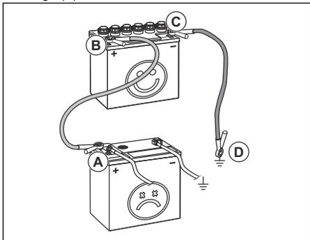
2. Conecte el otro extremo del cable rojo al terminal POSITIVO (+) de la batería a la batería totalmente cargada (B).
