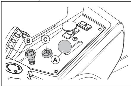
6. Si el motor está frío, tire del estrangulador (B) hacia arriba.
