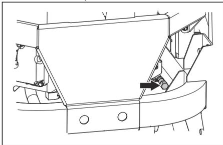
6. Coloque un recipiente debajo de la manguera de vaciado de aceite.
