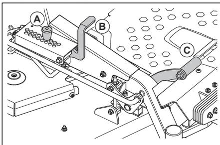
3. Pise el pedal de elevación del equipo (B) y tire hacia atrás la palanca de liberación de transporte (C) para bajar el equipo de corte a la posición de corte.
