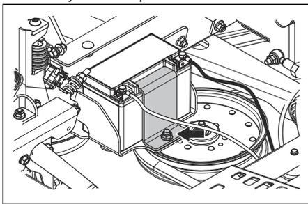
3. Utilice 2 llaves para desconectar el cable negro de la batería del terminal negativo (-) en la batería.
