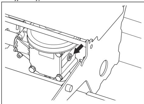
2. Pomocí olejového čerpadla vypusťte olej vypouštěcí zátkou.
