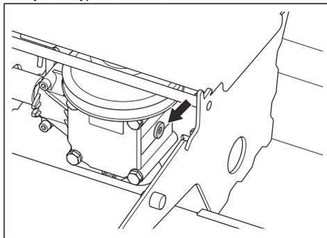
2. Olej odčerpajte cez vypúšťací uzáver pomocou olejového čerpadla.
