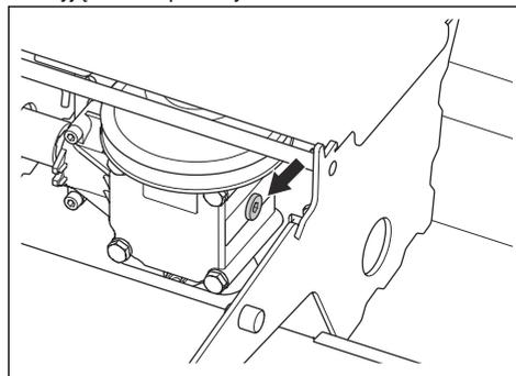
2. Za pomocą pompy oleju spuścić olej przez korek spustowy.
