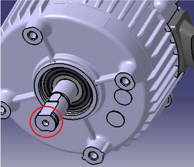
新割草系统 529 53 71-01 >（电机轴包括一个螺孔，见下文）仅与盘弹簧 597 67 01-01、垫圈 503 23 00-35 和螺丝 503 21 53-20 兼容。这种新割草系统包括电机 529 65 38-01。
