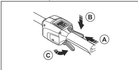
1. Controllare che la leva di comando sia bloccata quando il fermo si trova nella posizione iniziale.
