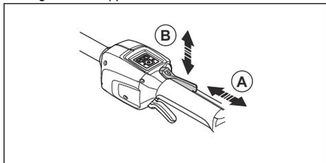
3. Controllare che la leva di comando e il blocco si muovano liberamente e che il sistema di molle funzioni correttamente.
