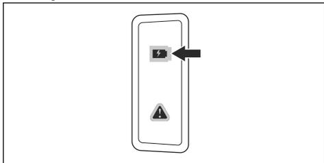
4. Quando tutti i LED sulla batteria sono accesi, la batteria è completamente carica.
