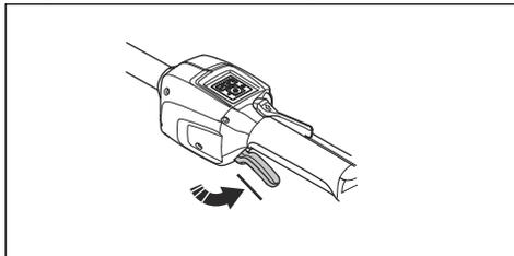
2. Spingere il blocco della leva di comando in avanti (A) e verso il basso. Premere il blocco della leva di comando (B) e controllare che ritorni nella posizione originale non appena viene rilasciato.
