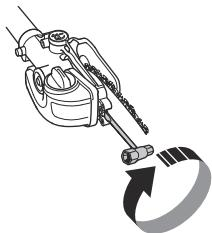
4. Naprężać łańcuch płyty, aż będzie ściśle przylegał do prowadnicy, ale nie za mocno, aby mógł się z łatwością poruszać.
