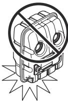
Tlumič výfuku je určen k omezení hladiny hluku na minimum a k usměrnění výfukových plynů směrem od obsluhy. V zemích s teplým a suchým počasím hrozí velké nebezpečí vzniku lesních požárů. Dodržujte místní předpisy a pokyny k údržbě.
