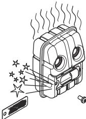
4. Oczyścić siatkę przeciwickrową, jeśli jest zapchana. W przypadku uszkodzenia wymienić.
