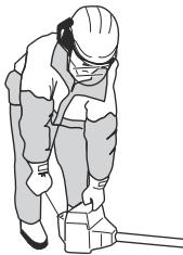
4. Tömmake käivitusnööri käepidet aeglasel, kuni tunnete kerget takistust, seejärel tömmake käivitusnööri käepidet jöuga.
