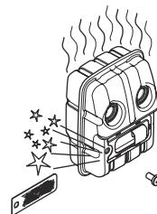
4. Oczyścić siatkę przeciwiskrową, jeśli jest zapchana. W przypadku uszkodzenia wymienić.
