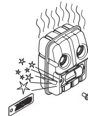
4. Pokud je lapač jisker znečištěný, vyčistěte jej, nebo vyměňte, pokud je poškozený.
