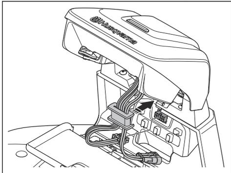
8. Conecte el cable de baja tensión a la estación de carga.
