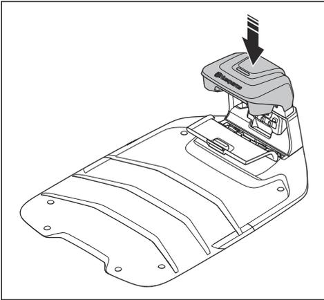
4. Eleve e incline la parte superior de la estación de carga.
