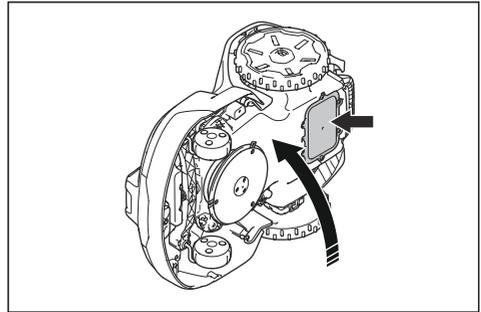
3. Quite los 6 tornillos de la cubierta de la batería.
