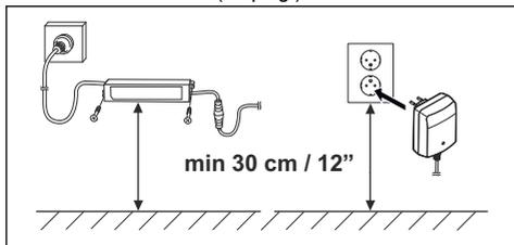
11. Conecte el cable de la fuente de alimentación a una toma de corriente de 100-240 V.
