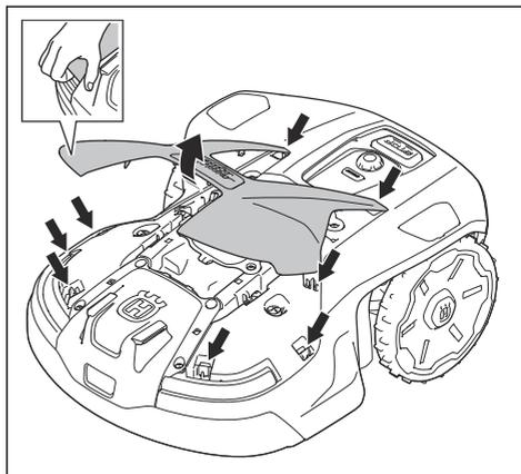
3. Sujete el chasis con una mano y retire la carrocería tirando rápida y brevemente hacia arriba y hacia la parte delantera del producto.
