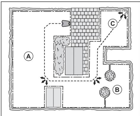
Cada área puede activarse o desactivarse. Utilice la función *Prueba* para medir la distancia desde la estación de carga hasta donde el producto debe comenzar a cortar. consulte *Medición de la distancia desde la estación de carga en la página 24*.
