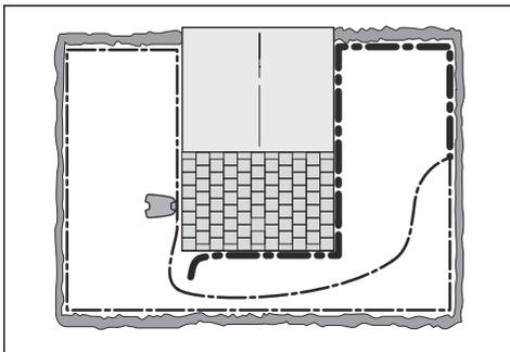
Continúe hasta que solo quede una sección muy corta del cable, que será la diferencia entre una luz verde fija y una luz azul intermitente. Después, siga las instrucciones del paso 5 a continuación.
