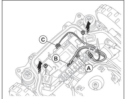
6. Trennen Sie das Kabel (C) von der vorderen Schleifen-Leiterplatte.
