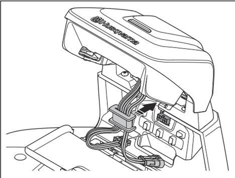
7. Schließen Sie das Netzteil an die Steckdose und die Ladestation an.
