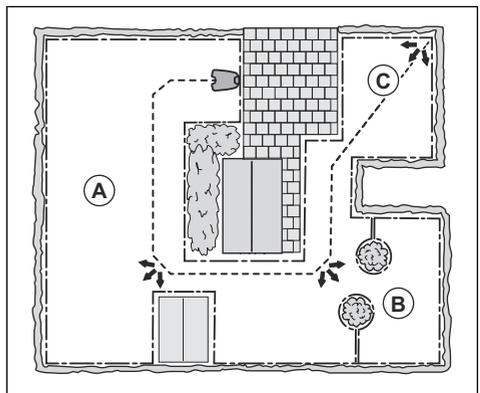
Jeder Bereich kann aktiviert oder deaktiviert werden. Verwenden Sie die *Testfunktion* zum Messen der Entfernung von der Ladestation bis zu dem Punkt, an dem das Gerät zu mähen beginnt. Siehe *So messen Sie die Entfernung von der Ladestation auf Seite 22*.
