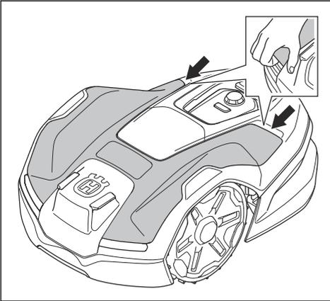
3. Halten Sie das Chassis mit einer Hand und entfernen Sie das Gehäuse mit einem schnellen und kurzen Zug nach oben und zur Vorderseite des Geräts.
