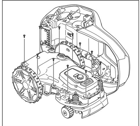
4. Entfernen Sie die Garantiesiegel, und heben Sie das untere Chassis an.
