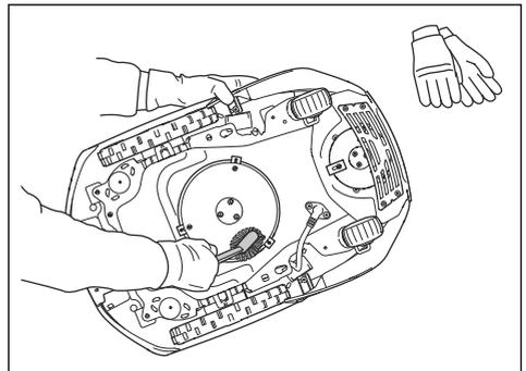
2. Reinigen Sie Klingenteller und Klingentellerschutz mit einer Bürste unter laufendem Wasser.
