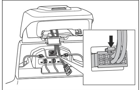
4. Entfernen Sie die Durchführung mit den Kabeln.
