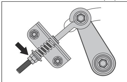
6. Retirer la courroie de la pompe du moteur et des poulies de la pompe.
