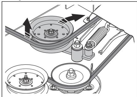
5. Retirer la courroie de l'unité de coupe de l'embrayage électrique se trouvant sur l'arbre du moteur.
