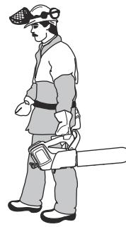
Zpětný vrh může být zcela nečekaný a velmi silný. Většina zpětných vrhů je však slabších a neaktivuje vždy brzdu řetězu. Pokud během používání výrobku dojde ke zpětnému vrhu, držte pevně rukojeti a nedovolte, aby vám vypadly z ruky.
