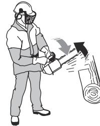
Používejte brzdu řetězu jako parkovací brzdu, když spouštíte výrobek a když se pohybujete na krátké vzdálenosti. Tím se sníží nebezpečí, že vy nebo osoba poblíž přijde do kontaktu s řetězem pily.
