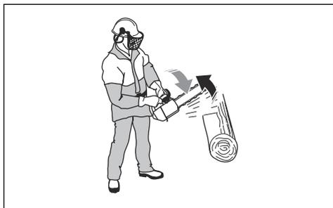
Utilize o travão da corrente como travão de estacionamento quando ligar o produto e se deslocar em distâncias curtas. Isto diminui o risco de o utilizador ou alguém próximo entrar em contacto com a corrente da serra.
