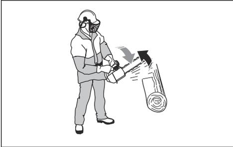
Utilice el freno de cadena como freno de estacionamiento cuando arranque el producto y cuando se mueva en distancias cortas. Esto reduce el riesgo de que usted o cualquier otra persona que se encuentre cerca toquen la cadena de sierra.
