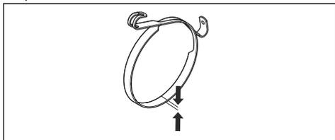
2. Controllare il nastro del freno. Il nastro del freno deve essere di almeno 0,6 mm di spessore nel punto di maggiore usura.
