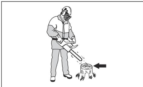
3. Se la lubrificazione della catena non funziona correttamente, eseguire un controllo della barra di guida. Per le istruzioni, fare riferimento a *Controllo della barra guida alla pagina 32*. Rivolgetevi al vostro rivenditore se le operazioni di manutenzione non risolvono il problema.
