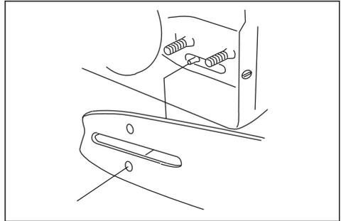
7. Serrare con le dita i dadi di fissaggio della barra.
