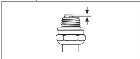
4. Sostituire la candela almeno una volta al mese o più frequentemente, se necessario.
