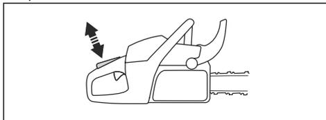
3. Assicurarsi che il grilletto dell'acceleratore sia bloccato sul minimo quando il blocco del grilletto dell'acceleratore viene rilasciato.
