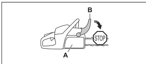
Spostare in avanti la protezione anticuntraccolpo per disinserire il freno della catena.
