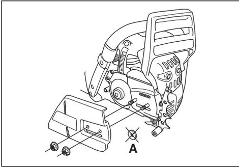
**Nota:** Se il coperchio della frizione risulta difficile da rimuovere, serrare il dado della barra, innestare il freno della catena e rilasciare. Se si rilascia correttamente, si sente un clic.
