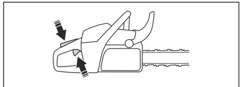
8. Muovere in avanti la protezione anticuntraccolpo per disinserire il freno della catena.
