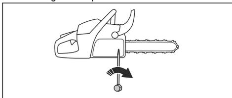
5. Serrare i dadi della barra di guida con la chiave e sollevare contemporaneamente la parte anteriore della barra di guida.
