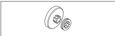
1. Assicurarsi che l'anello pignone non sia usurato. Sostituire se necessario.
