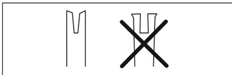
5. Verificare se la punta della barra di guida è irregolare o molto usurata.
