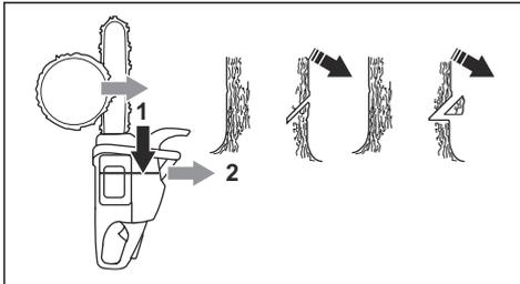
2. 受け口下部が水平で、倒す方向に対して  $90^{\circ}$  であることを確認します。
