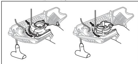
5. 545 Mark II, 545G Mark II : センターボルト (A)、スリーブ (B)、スプリング (C) を取り外します。
