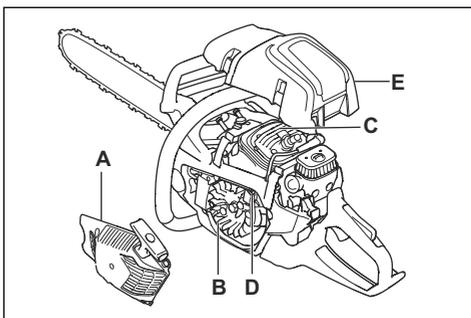
1. 必要に応じて、ブラシを使用して週に 1 回以上の頻度で冷却システムを清掃してください。
