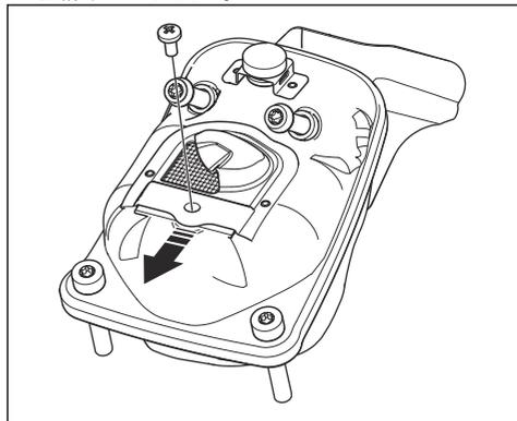
4. 破損したスパーク防止ネットは交換してください。
