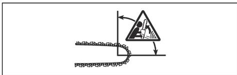
キックバックは、常にガイドバーの切削面で起こります。通常、本体は作業者に向かって跳ね返りますが、別の方向に向かう場合もあります。キックバック発生時に本製品をどのように使用していたかによって、キックバックの動きの方向が決まります。
