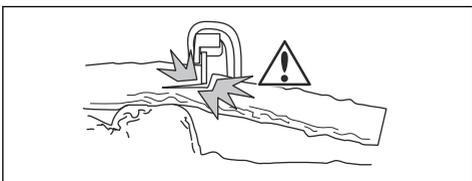
1. 幹を押し切りで約 1/3 切断します。
