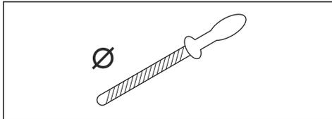
ソーチェンの目立てを正しく行うには、適切な装置を使用する必要があります。Husqvarna 推奨の目立てゲージを使用してください。最高の切削性能を得ることができ、キックバックの危険も最小限に抑えられます。
