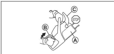
Spostare in avanti la protezione antictraccolpo (C) per disinserire il freno della catena.
