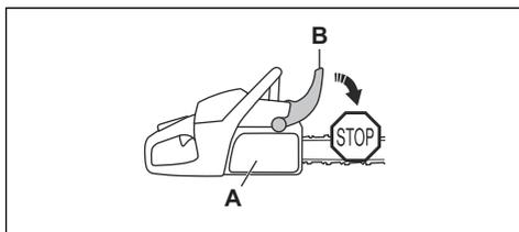
Spostare in avanti la protezione antictraccolpo per disinserire il freno della catena.
