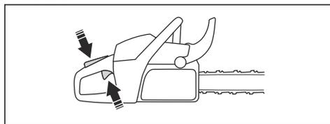
8. Muovere in avanti la protezione anticontraccolpo per disinserire il freno della catena.
