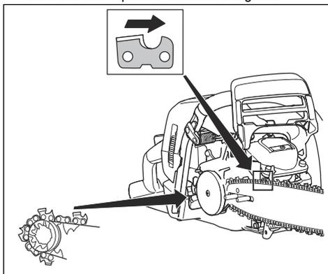
6. Allineare il foro della barra di guida con il fermo tendicatena e montare il coperchio della frizione.
