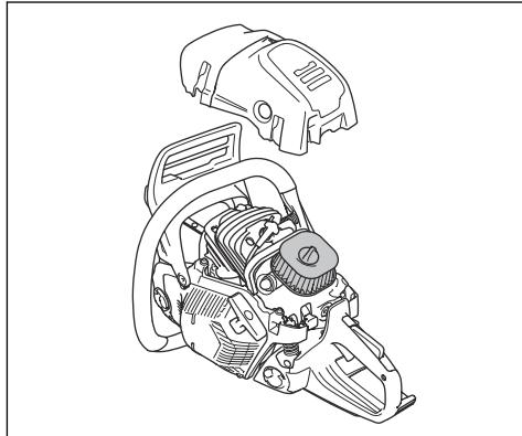
**Περιεχόμενα** Το προϊόν μπορεί να χρησιμοποιηθεί με διάφορους τύπους φίλτρου αέρα ανάλογα με τις διάφορες συνθήκες εργασίας, τις καιρικές συνθήκες και την εποχή. Απευθυνθείτε στον αντιπρόσωπο σέρβις για περισσότερες πληροφορίες.
