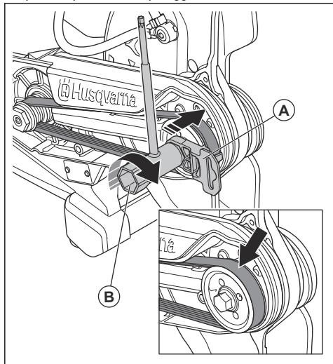
3. Ruotare la puleggia anteriore in senso orario utilizzando la chiave combinata (B). Allo stesso tempo, spingere la cinghia di trasmissione sulla puleggia.
