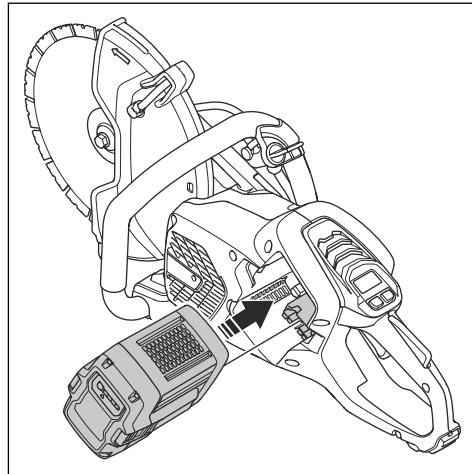
3. Premere sulla parte inferiore della batteria fin quando non si percepisce uno scatto. Se la batteria non si muove facilmente nel relativo supporto, non è collegata correttamente nel supporto della batteria.
