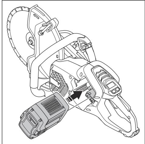
3. Prima a parte inferior da bateria até ouvir um som de clique. Se a bateria não se mover facilmente para o respetivo suporte, não está devidamente fixada no suporte da bateria.
