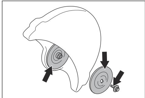
2. Asegúrese de que las áreas de contacto del disco de corte y las arandelas de collarín no están dañadas. Sustituya las piezas dañadas.
