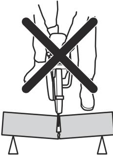
Si el disco se atasca o se engancha en el sector de riesgo de reculada, la fuerza reactiva empujará la cortadora hacia arriba y hacia atrás en dirección al usuario con un movimiento giratorio, lo que podría provocar daños graves o mortales. Preste atención al posible movimiento de la pieza de trabajo. Si la pieza de trabajo no está correctamente sujetada y se mueve durante el corte, se podría atascar el disco y provocar una violenta sacudida.
