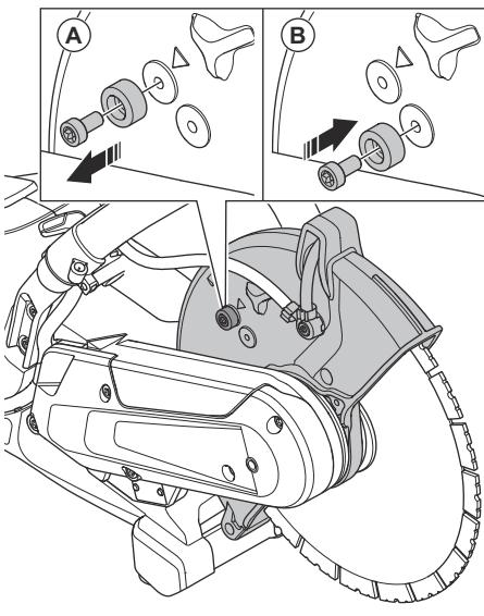
2. Για να ενεργοποιήσετε τη λειτουργία κοπής σωλήνων, τραβήξτε τη λαβή ρύθμισης.
