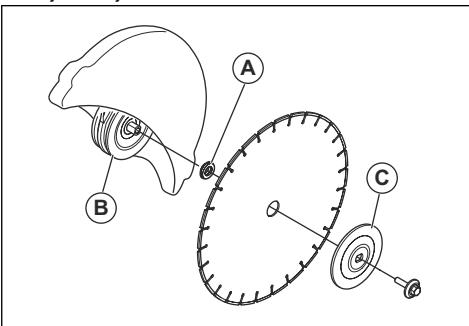
3. Coloque una herramienta en el orificio de la protección de la correa y gire el disco de corte hasta que se bloquee el eje.
