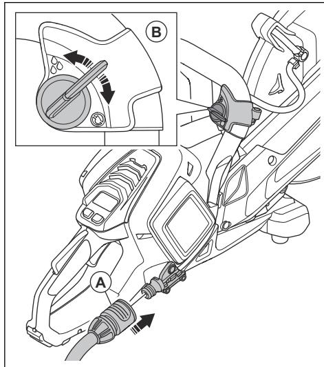
2. Ruotare la valvola dell'acqua (B) per avviare o arrestare il flusso dell'acqua.
