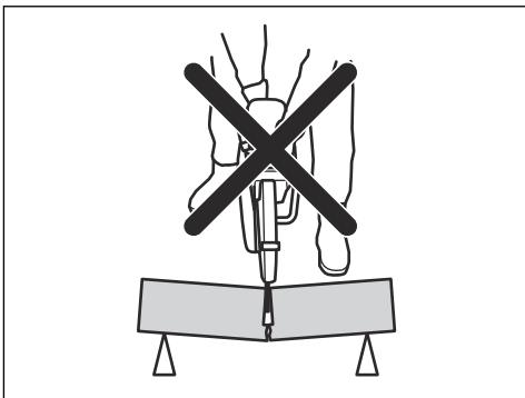
Se il disco è schiacciato o bloccato nel settore di contraccolpo, la forza di reazione respingerà la troncatrice in senso rotatorio in alto e indietro verso l'utente causando lesioni gravi o mortali. Fare attenzione al possibile spostamento del pezzo in lavorazione. Se esso non è adeguatamente supportato e si sposta durante il taglio, potrebbe schiacciare la lama e causare un contraccolpo.
