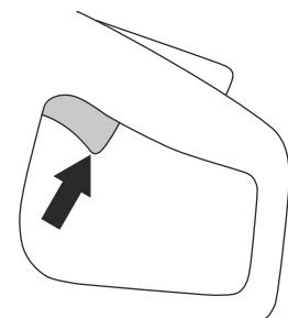
5. Rilasciare la leva di comando e accertarsi che il disco di taglio si arresti. Se il disco di taglio gira con la leva di comando al minimo, contattare il centro di assistenza.
