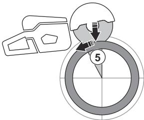
**AVVERTENZA:** Se il tubo è sostenuto correttamente, non dovrebbe inceppare il disco quando viene separato nella sezione 5. Tuttavia, prestare attenzione se il disco si inceppa durante la separazione finale. Se il disco si inceppa nella sezione inferiore, il prodotto potrebbe allontanarsi dall'operatore, anziché causare un contraccolpo rotante.
