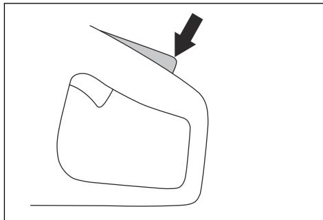
3. Assicurarsi che la leva di comando sia bloccata sul minimo quando viene rilasciato il fermo della leva di comando.
