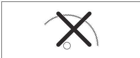
A utilização deste cortador de disco com uma lâmina de dentes de pastilha de carbono constitui uma violação dos regulamentos de segurança no trabalho.
