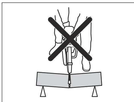
Caso a lâmina fique presa ou entalada na zona de retrocesso, a força reactiva faz com que a máquina seja arremessada para cima e para trás num movimento rotativo, podendo causar ferimentos graves e mesmo mortais. Tenha atenção à possibilidade de deslocação da peça em que está a trabalhar. Se a peça em que está a trabalhar não estiver devidamente apoiada e se deslocar durante o corte, poderá prender a lâmina e provocar um retrocesso.
