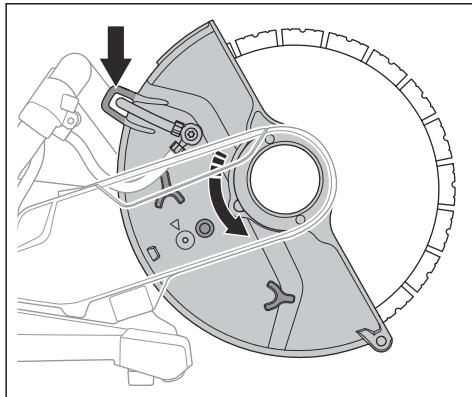
3. Riportare il bullone di arresto nella modalità di taglio standard dopo l'operazione di taglio dei tubi. La freccia (A) mostra la modalità di taglio standard.
