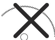
El uso de esta cortadora con un disco con punta de carburo es contrario a las normas de seguridad en el trabajo.
