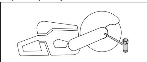
4. Apriete el perno del disco de corte a 30 Nm (18,5 ft-lb).
