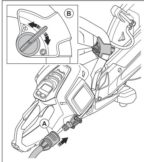
2. Rode a válvula de água (B) para iniciar ou parar o fluxo de água.
