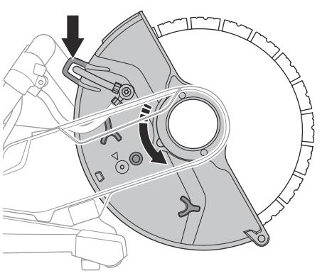
3. Μετά από τη διαδικασία κοπής σωλήνων, επιαναφέρετε τη βίδα αναστολής κίνησης στη θέση της τυπικής λειτουργίας κοπής. Το βέλος (A) δείχνει τη θέση της τυπικής λειτουργίας κοπής.
