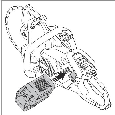
3. Presione la parte inferior de la batería hasta que oiga un clic. Si no puede insertar la batería en el soporte con facilidad, no se acoplará correctamente.
