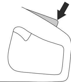
3. Asegúrese de que el gatillo de alimentación se bloquee en la posición de ralentí cuando el bloqueo se suelta.
