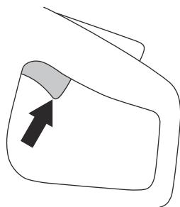
5. Suelte el gatillo de alimentación y asegúrese de que el disco de corte se detiene. Si el disco de corte gira cuando el gatillo de alimentación está en posición de ralentí, póngase en contacto con su taller de servicio.
