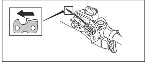
4. Montare il coperchio e individuare il fermo tendicatena (A) nel foro sulla barra. Controllare che le maglie di trascinamento della catena ingranino correttamente nel pignone guida (B) e che la catena sia posizionata nella scanalatura della barra (C). Serrare manualmente il dado della barra.
