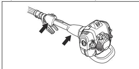
3. Assicurarsi di montare gli elementi del sistema di smorzamento delle vibrazioni in modo corretto.
