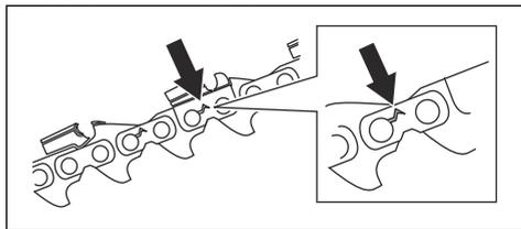
2. Assicurarsi che la catena sia facile da tendere. Sostituire la catena se è rigida.
