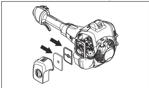
3. Pulire i filtri dell'aria con acqua calda e sapone.
