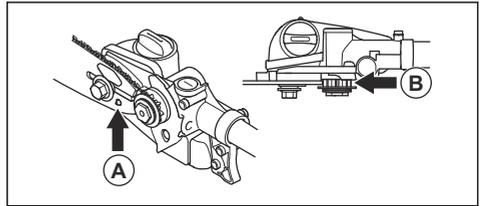
5. Tendere la catena con la vite apposita e la chiave combinata avvitandola in senso orario. La tensione è corretta quando la catena rimane nella scanalatura intorno alla lama.
