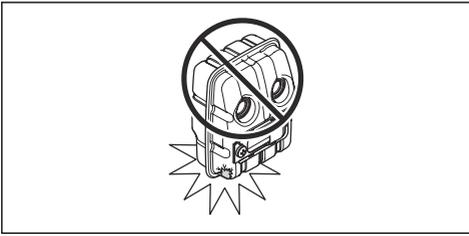
La marmitta assicura il minimo livello acustico e allontana i fumi di scarico dall'operatore. In aree dal clima caldo e asciutto può sussistere un grosso rischio di incendi. Rispettare le norme locali e le istruzioni di manutenzione.
