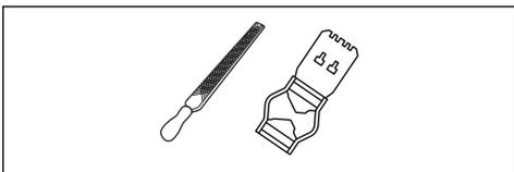
1. Utilizzare una lima piatta e uno strumento di misurazione del calibro di profondità per questa impostazione. Utilizzare esclusivamente il nostro strumento di misurazione del calibro di profondità Husqvarna per avere profondità e angolo corretti.
