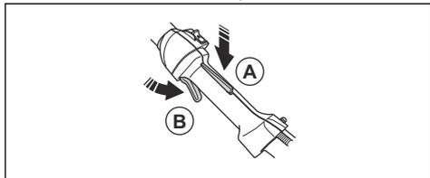
2. Rilasciare il blocco del grilletto acceleratore e accertarsi che il comando dell'acceleratore sia bloccato nella posizione del regime minimo.
