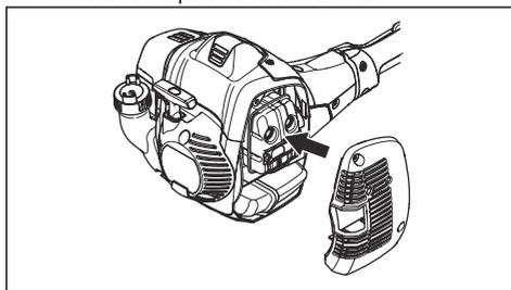
3. Rimuovere la vite di fissaggio della retina parascintille.
