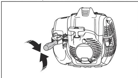
4. Ruotare la vite di regolazione del minimo in senso antiorario fino a quando la catena non si arresta.
