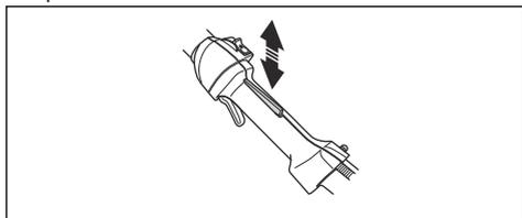
4. Controllare che il comando dell'acceleratore e il blocco del grilletto acceleratore si muovano liberamente e che le molle di richiamo funzionino correttamente.
