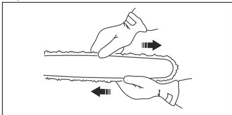
7. Controllare spesso la tensione di una nuova catena fino al termine del rodaggio. Controllare regolarmente la tensione della catena. Una catena correttamente tesa significa migliori caratteristiche di taglio e lunga durata.
