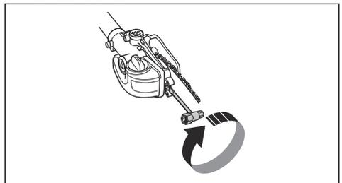
6. La tensione è corretta quando la catena rimane nella scanalatura intorno alla lama ed è possibile farla scorrere con le dita, senza sforzo. Serrare a fondo i dadi con la chiave combinata tenendo sollevata la punta della lama.
