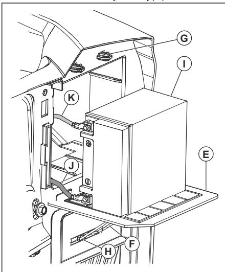
6. Akumulatoriaus durelių atramą įstatykite į angą (H), esančią po akumulatoriaus durelėmis.
