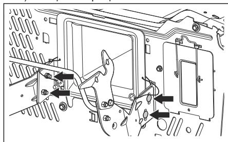
b) Deplasați consolele în poziția corectă.
