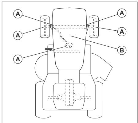
A. Ungerea generală. Lubrificați conexiunea de ungere a pivotului, rulmentul roții din față, dantura pinioanelor coloanei de direcție.
