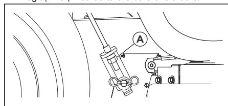
**Nota:** Fiecare rotire completă a piuliței de reglare a ridicării modifică înălțimea capului tăietor cu aproximativ 3/16" (4,7 mm).
