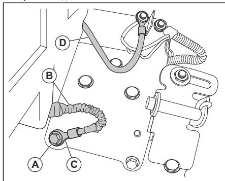
2. С помощью гаечного ключа 13 мм (1/2 дюйма) или торцевого ключа открутите серебристый винт заземления. Не утилизируйте винт серебристый винт заземления.
