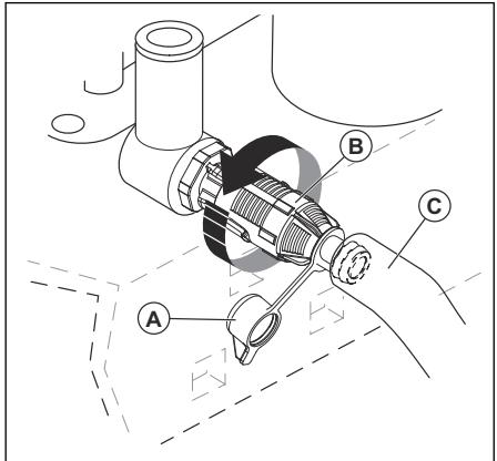
5. Монтирайте маркуча за източване на маслото (C) към крана за източване на маслото.
