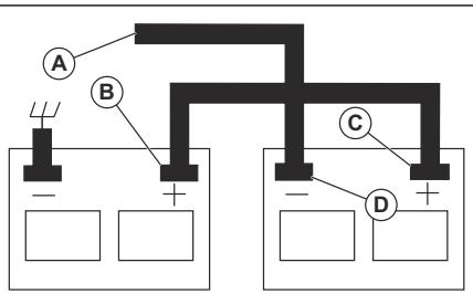
1. Conectați capetele cablului ROȘU la bornele POZITIVE (+) ale ambelor baterii (B-C).
