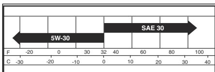
**Примечание:** Мультивязкостные масла (5W30, 10W30 и т.д.) упрощают запуск двигателя в холодную погоду, однако работа при температуре выше 0 °C / 32 °F может
