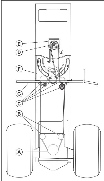
6. Снимите приводной ремень со средних промежуточных шкивов (C).
