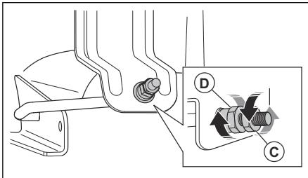
8. Отрегулируйте высоту режущей деки с помощью гаечного ключа 3/4".
