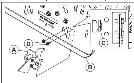
4. Убедитесь, что пружинные защелки входят в зацепление с пазами (C) на крепежной пластине.
