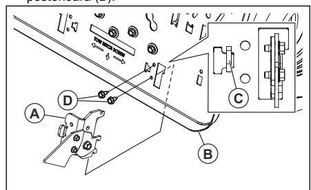
4. Asigurați-vă că zăvoarele cu arc se conectează la fantele (C) din placă posterioară.
