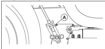
**Piezīme:** Katrs pilns regulēšanas uzgriežņa apgrieziens maina plaušanas bloka augstumu par aptuveni 3/16 collām (4,7 mm).
