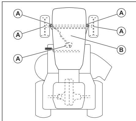
A. Üldine määrimine. Määrite spindli määrduehendust, esiratta laagrit, roolisüsteemi rataste hamblaid.
