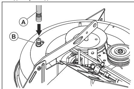
7. Дръпнете назад заключващия пръстен на адаптера на дюзата и натиснете последния върху порта за измиване на платформата (B).
