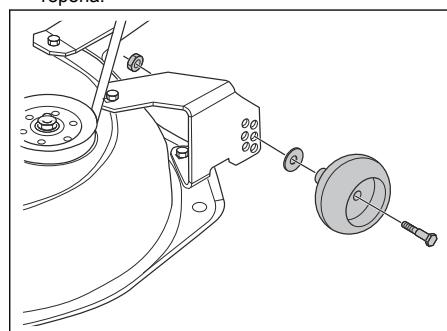
4. Монтирайте колелото, предпазващо от оголоване на терена, болта, шайбата и гайката в правилното положение.
