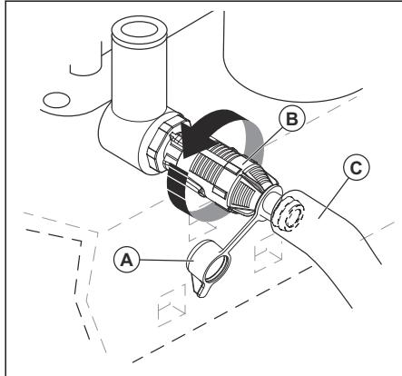
5. Montați furtunul de golire (C) pe supapa de golire a uleiului.
