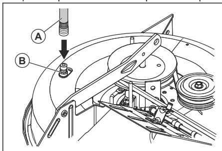
7. Pavelciet atpakaļ sprauslas adaptera fiksējošo gredzenu un uzspiediet sprauslas adapteri uz pamatnes skalošanas pieslēgvietas (B).
