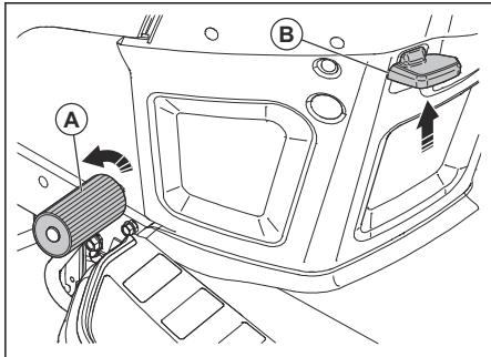
2. Kui piduripedaal on alla vajutatud, siis tömmake üles seisupiduri hoop (B).
