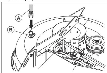
7. Trageți înapoi colierul de blocare al adaptorului pentru ajutaj și împingeți adaptorul pentru ajutaj pe portul de spălare a capului tăietor (B).
