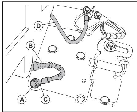
2. Folosiți o cheie fixă sau tubulară de 1/2 in (13 mm) pentru a scoate șurubul argintiu de împământare. Nu aruncați șurubul argintiu de împământare.
