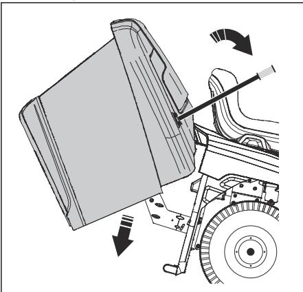
5. Împingeți mânerul în spate pentru a coborî colectorul de iarbă. Asigurați-vă că colectorul de iarbă este complet coborât și în poziție corectă.
