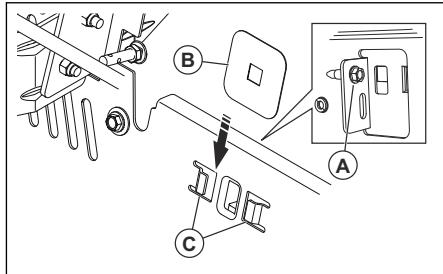
4. Установите защитную пластину рычага (B) в пазы (C).
