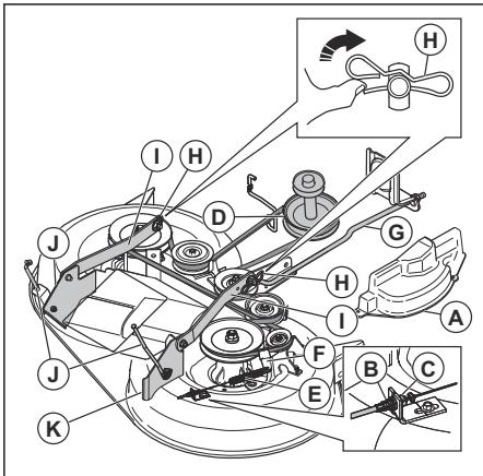
6. Снимите трос муфты (B), надавите на выступ (C) и извлеките трос муфты из кронштейна.
