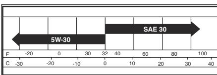
**Nota:** Uleiurile multigrad (5W30, 10W30 etc.) contribuie la o pornire mai ușoară a motorului în sezonul rece, dar duc la un grad crescut de utilizare a uleiului atunci când sunt utilizate la temperaturi de peste 32 °F / 0 °C. Verificați nivelul uleiului mai
