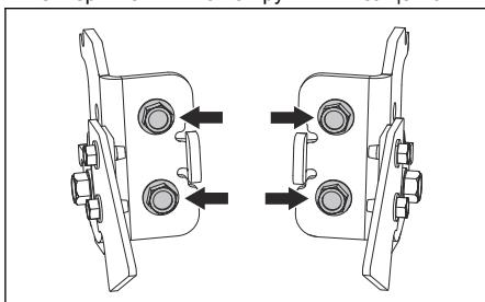
3. Установите пружинные защелки (A) в отверстия в крепежной пластине (B).
