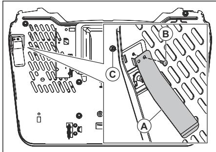
3. Instalați șurubul (B) și șaiba (C).
