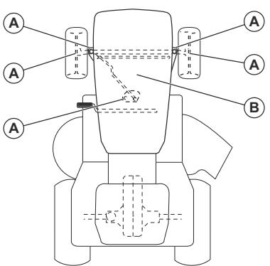
A. Общо смазване Смажете връзката за гресиране на шпиндела, лагера на предното колело и зъбите на кормилната част.
