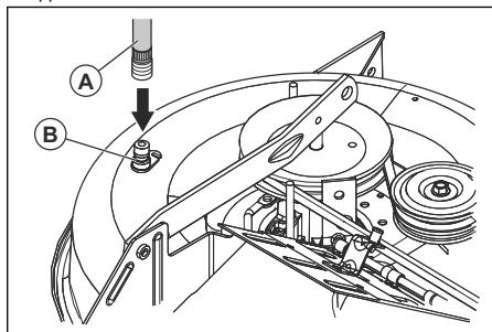
7. Оттяните зажимное кольцо переходника для сопла, чтобы подсоединить переходник для сопла к промывочному патрубку (B).
