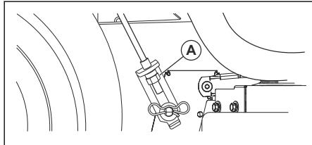
**Примечание:** Каждый полный оборот гайки регулировки подъема изменяет высоту режущей деки примерно на 4,7 мм (3/16 дюйма).
