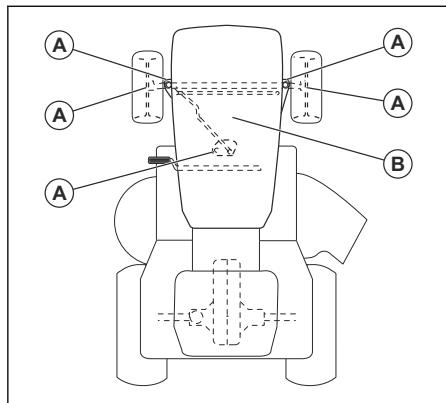
**A.** Общая смазка. Смажьте смазочное соединение шпинделя, подшипник переднего колеса, зубья шестерни механизма рулевого управления.
