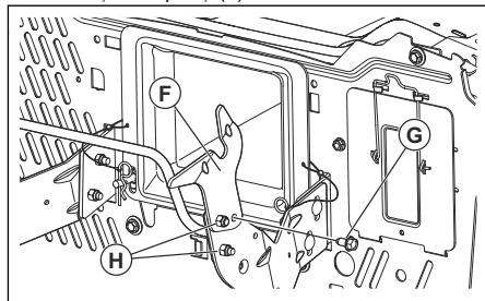
4. Instalați cele 2 șuruburi cu cap cu șaibă (G).
