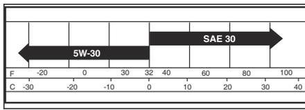
**Poznámka:** Multiviskozitné oleje (5W30, 10W30 ap.) slúžia ako pomôcka na jednoduché štartovanie motora v studenom počasí, spôsobujú však vyššiu spotrebu oleja v prípade ich použitia pri teplotách vyšších než 32 °F/0 °C. Často kontrolujte hladinu oleja, aby nedošlo k poškodeniu motora v dôsledku nízkej hladiny oleja.
