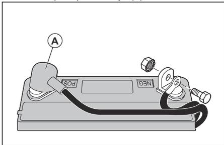
4. Uklonite vijak i maticu kako biste crni (negativni) kabel baterije odspojili od negativne (-) stezaljke.
