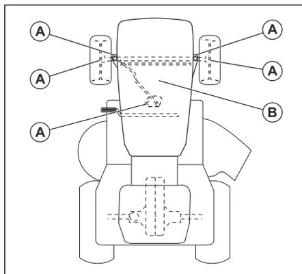
A. Opće podmazivanje. Podmažite priključak za podmazivanje vratila, ležaj prednjeg kotača i zupce zupčanika upravljačkog dijela.
