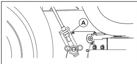
**Uwaga:** Każdy pełny obrót nakrętki regulującej powoduje zmianę wysokości zespołu tnącego o 3/16" (4,7 mm).
