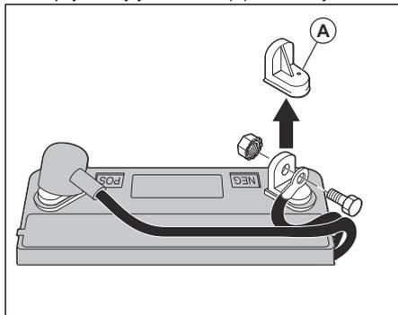
4. Prípojte červený kábel akumulátora ku kladnému (+) kontaktu a podľa vyobrazenia dotiahnite skrutku a maticu. Na kontakt nasadte kryt kontaktu.
