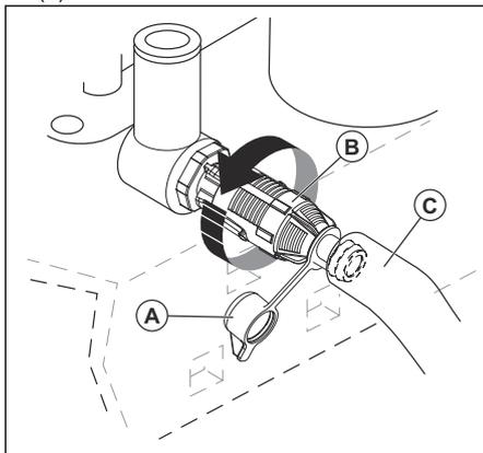
5. Zamontować przewód spustowy oleju (C) do zaworu spustowego oleju.
