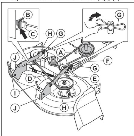
5. Demontujte lanko spojky (B), zatlačte jazýček (C) a vytáhněte lanko spojky z držáku.
