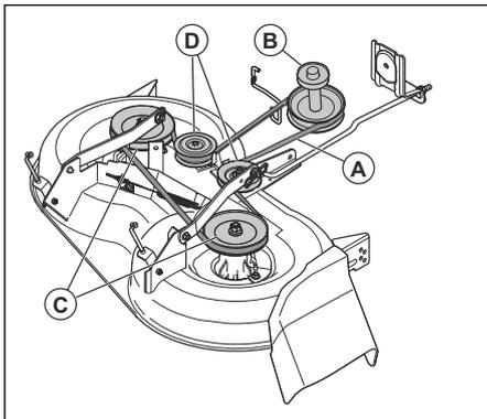
5. Odnímate hnací remeň z remeníc trňov (C) a remenic napínača (D).
