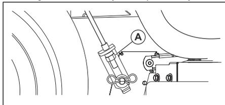
**Opomba:** Z vsakim polnim obratom nastavitvene matice dvizhnega priklopa spremenite višino kosišča za 4,7 mm (3/16 palca).
