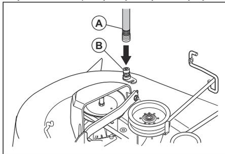
7. Odciągnąć pierścień blokujący łącznika dyszy, aby wcisnąć łącznik dyszy w port przepłukiwania zespołu (B).
