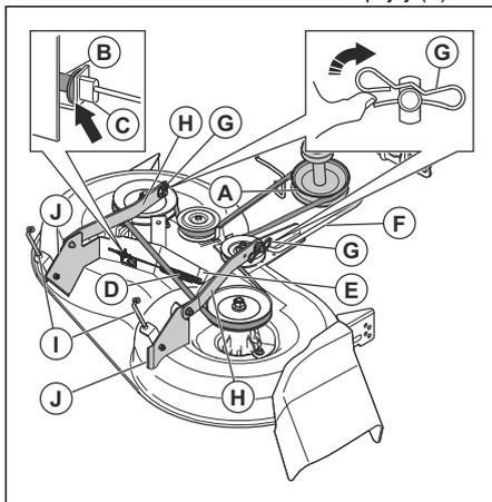
5. Odnímate kábel spojky (B), zatlačte plošku (C) a vyberte káble spojky von z konzoly.
