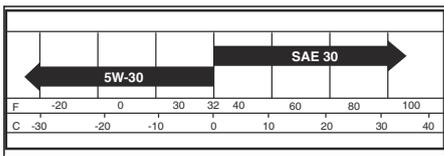
**Napomena:** Ulja s višestrukim viskoznostima (5W30, 10W30 i tako dalje) pomažu olakšava pokretanje motora po hladnom vremenu, no povećava potrošnju ulja kada je temperatura viša od 32 °F/0 °C. Redovito provjeravajte razinu ulja u motoru kako biste spriječili moguća oštećenja motora uzrokovana niskom razinom ulja.
