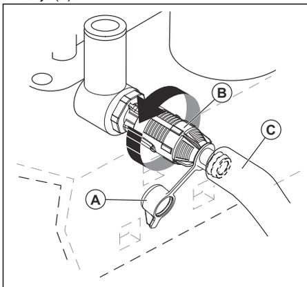
5. Namontujte vypouštěcí trubičku oleje (C) na vypouštěcí ventil.
