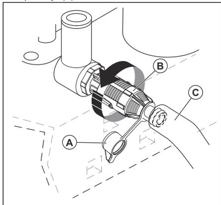
5. Namestite cev za izpust olja (C) na ventil za izpust olja.
