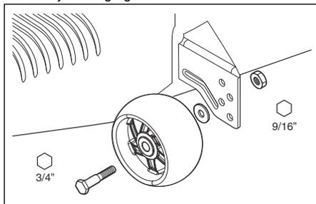
4. Szerelje fel a talajkövető görgőt, a csavart, az alátétet és az anyát a megfelelő helyzetbe.
