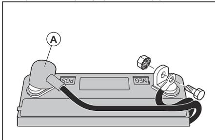
4. Wykręcić śrubę i nakrętkę, aby odłączyć czarny (ujemny) przewód akumulatora od bieguna ujemnego (-) akumulatora.
