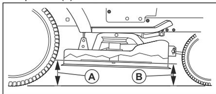
**Povšimněte si:** Nejlepších výsledků sečení výrobek dosáhnete, když jsou v nejvyšší poloze žacího ústrojí nože nastaveny tak, že je přední konec o 3,1 až 12,7 mm (1/8 až 1/2 palce) níže než zadní.
