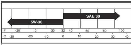
**Opomba:** Olja za več razredov viskoznosti (5W-30, 10W-30 itn.) sicer pomagajo, da se motor enostavno zažene v hladnem vremenu, vendar pa povečujejo porabo olja pri uporabi pri temperaturah nad 0 °C (32 °F). Pogosteje preverjajte nivo motornega olja, da preprečite poškodbe motorja zaradi prenizkega nivoja olja.
