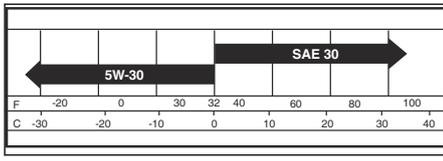
**Megjegyzés:** A többfokozatú olajak (5W30, 10W30 stb.) hideg időben elősegítik a motor beindítását, ugyanakkor 0 °C (32 °F) feletti hőmérsékleten megnő ezeknél az olajfogyasztás. Az alacsony olajsint miatti esetleges motorkárosodás megelőzése érdekében gyakran végezze el az olajsint ellenőrzését.
