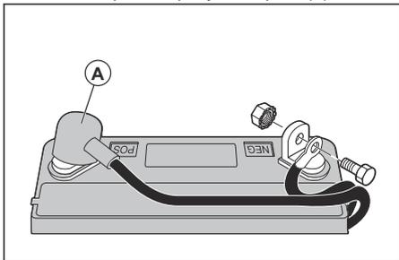
4. Odstranite vijak in matico, da odklopite črni (negativni) kabel akumulatorja z negativne (-) priključne sponke.
