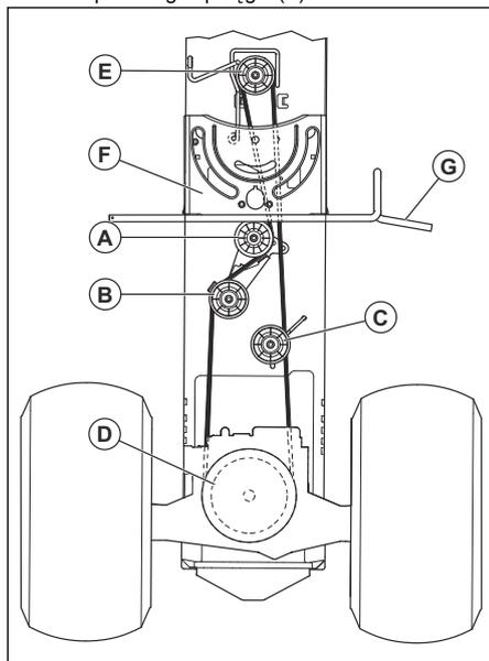
4. Zdjąć pasek napędowy z koła pasowego napinającego pasek (C).
