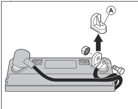
4. Podłączyć czerwony przewód akumulatora do dodatniego zacisku (+), a następnie dokręcić śrubę i nakrętkę zgodnie z rysunkiem. Przesunąć pokrywę zacisku na zacisk.
