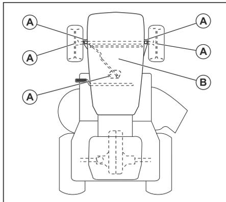
A. Běžné mazání Promažte maznici vřetena, ložisko předního kola, zuby ozubeného kola části řízení.
