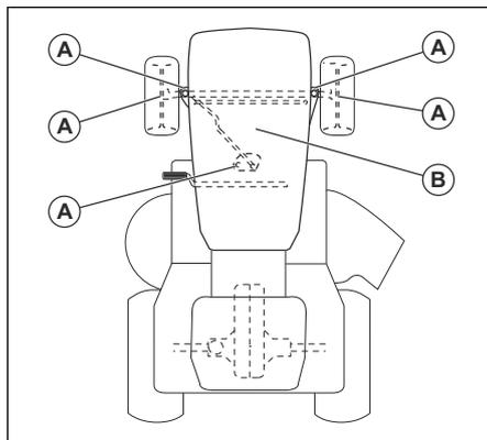
A. Splošno mazanje. Namažite mazalko vretena, ležaj sprednjih koles in zobe zobnika krmilnega dela.
