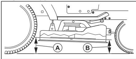
**Uwaga:** W celu uzyskania najlepszych rezultatów koszenia noże urządzenia tnącego powinny zostać ustawione tak, aby ich przednia krawędź znajdowała się od 1/8" do 1/2" (od 3,1
