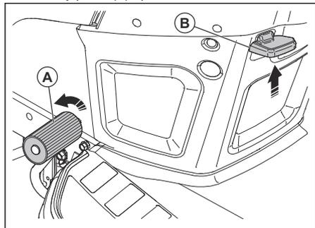
2. S brzdovým pedálom v spodnej polohe potiahnite parkovaciu brzdzu (B) nahor.
