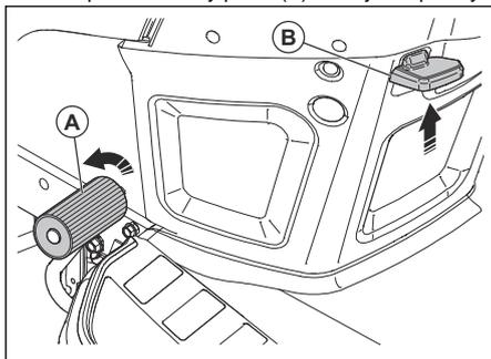
2. Sešlápněte brzdový pedál a vytáhněte páku parkovací brzdy (B) nahoru.
