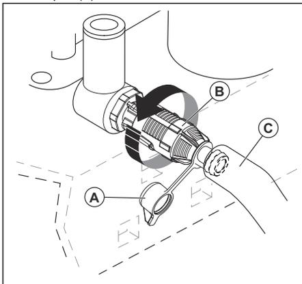
5. Szerelje fel az olajleeresztő tömlőt (C) az olajleeresztő szelepre.
