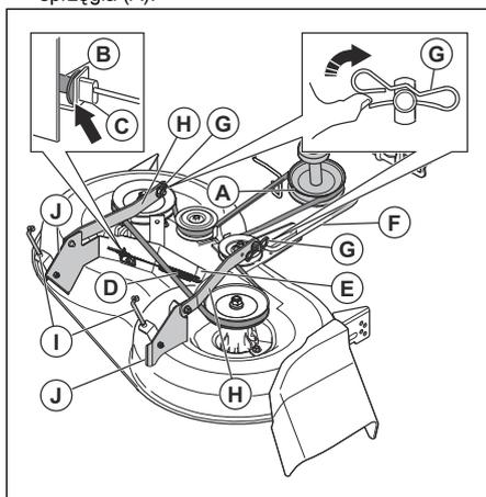
5. Wymontować linkę sprzęgła (B), wcisnąć występ (C) i wysunąć linkę sprzęgła ze wspornika.
