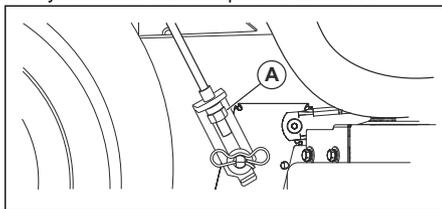
**Povšimněte si:** Každou celou otáčkou seřizovací matice zdvíhu docílíte změny výšky žacího ústrojí o 4,7 mm (3/16").
