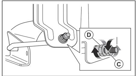
8. Visinu reznog kućišta podešavajte ključem od 3/4".
