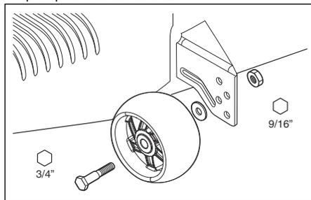
4. Nasadíte koliesko proti poškodeniu trávniká, skrutku, podložku a maticu v správnej polohe.
