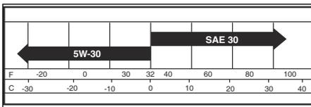
**Uwaga:** Oleje o zmiennej lepkości (5W30, 10W30 itp.) ułatwiają rozruch silnika w niskiej temperaturze otoczenia, ale powodują zwiększone zużycie oleju w temperaturze powyżej 0°C/32°F. Należy często sprawdzać poziom oleju w silniku, aby
