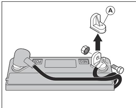
4. Csatlakoztassa a piros színű akkumulátorkábel a pozitív (+) saruhoz, és szorítsa meg a csavart és az anyacsavart az ábrán látható módon. Helyezze rá a saruvédőt a sarura.
