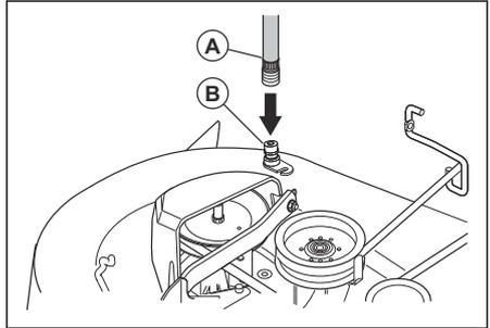
7. Potiahnite poistný prsteneц adaptéra dýzy dozadu a pritlačte adaptér k preplachovaciemu výstupu (B).
