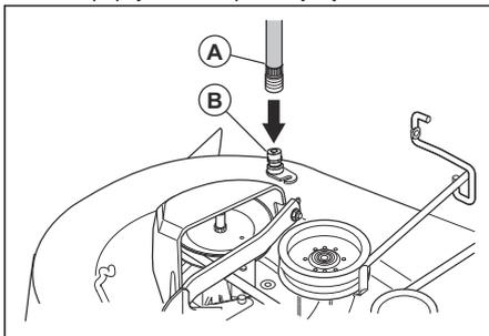
7. Stáhněte blokovací kroužek adaptéru trysky a zatlačte adaptér trysky na přípojku pro mytí (B).
