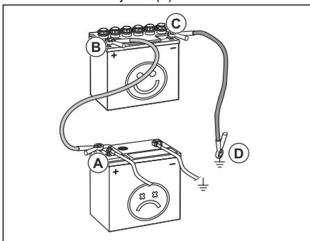
2. Csatlakoztassa a piros akkumulátorkábel másik végét a feltöltött akkumulátor POZITÍV (+) akkumulátorsarujához (B).
