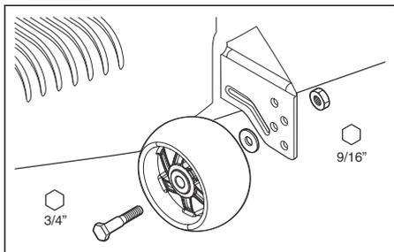
4. Ugradite kotačić reznog kućišta, vijak, podlošku i maticu u ispravan položaj.
