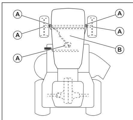
A. Všeobecné mazanie. Namažte mazacie pripojenie vretena, ložisko predného kolesa, ozubené koliesko dielu riadenia.
