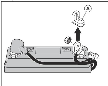
4. Crveni akumulatorski kabel priključite na pozitivni (+) pol i zategnite vijak i maticu kako je prikazano. Uklonite poklopac pola s pola.
