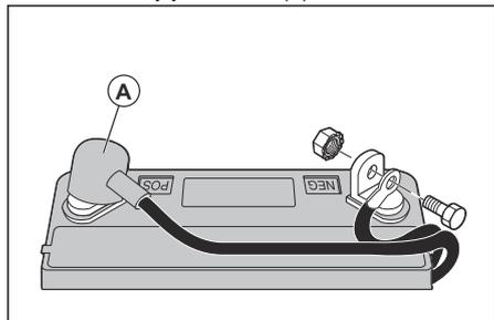
4. Odstráňte skrutku a maticu a odpojte čierny (záporný) kábel akumulátora zo záporného (-) kontaktu.
