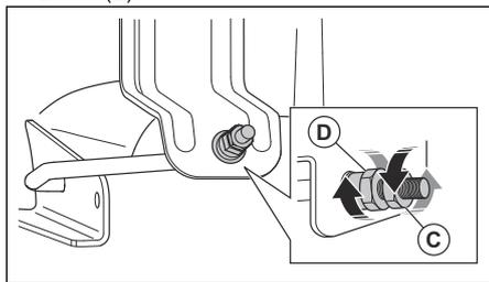
8. Nastavte výšku žacího ústrojí pomocí klíče 3/4".
