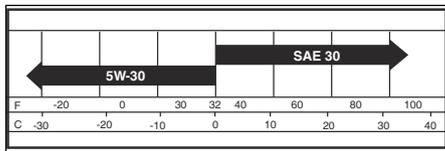
**Povšimněte si:** I když multiviskózní oleje (5W30, 10W30 atd.) zlepšují spouštění za studena počasí, při použití nad 0 °C (32 °F) způsobují vyšší spotřebu oleje. Hladinu oleje často kontrolujte, aby nedošlo k poškození motoru kvůli nízké hladině oleje.
