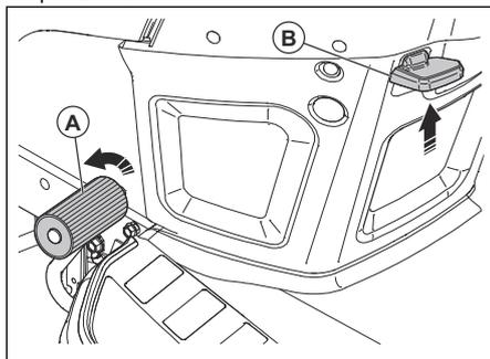
2. Przy wciśniętym pedale hamulca pociągnąć dźwignię hamulca postojowego (B) w górę.
