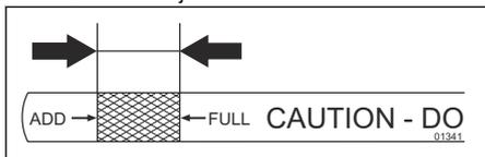
5. Zasuňte olejovú mierku do olejovej plniacej trubice. Uistite sa, že uzáver plniaceho hrdla oleja je kompletne zatiahnutý.
