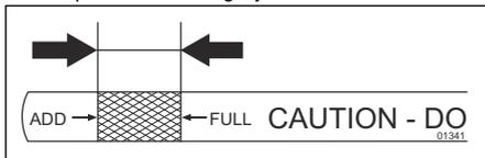
5. Umetnite šipku za mjerenje ulja u cijev za ulijevanje ulja. Provjerite je li čep za punjenje ulja potpuno zategnut.
