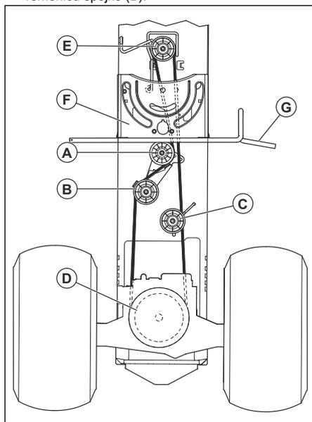
4. Skinite pogonski remen s remenice za zatezanje remena (C).
