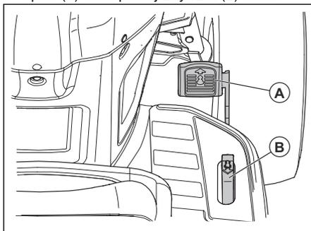
**Poznámka:** Pedále jazdy vpred a vzad sa po uvoľnení vrátia do neutrálnej polohy.
