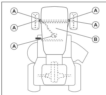
A. Ogólne smarowanie. Nasmarować połączenie smarowania trzpienia obrotowego, łożysko koła
