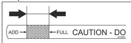
5. Vložte olejovou měрку do plnicí trubky oleje. Zkontrolujte, zda je plnicí uzávěr oleje pevně dotažený.
