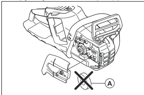
3. Posizionare la barra di guida sopra il bullone della barra. Portare la barra di guida nella sua posizione piú arretrata. Sollevare la catena sopra il pignone guida e inserirla nella scanalatura sulla barra di guida. Cominciare dalla parte superiore della barra di guida.
