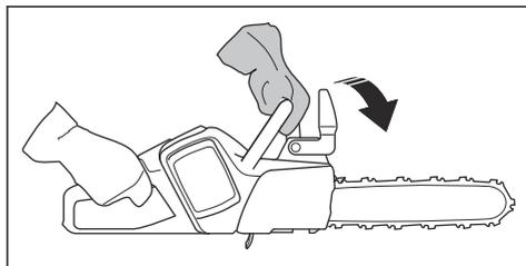
In posizione di abbattimento non è possibile innestare manualmente il freno della catena. Il freno della catena può essere innestato in questa posizione solo tramite il meccanismo di attivazione inerziale.
