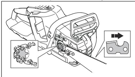
5. Montare il coperchio del pignone guida e inserire il fermo tendicatena nel foro sulla barra di guida.
