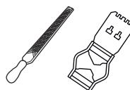
1. Χρησιμοποιήστε μια επίπεδη λίμα και ένα όργανο μέτρησης βάθους για να προσαρμόσετε τη ρύθμιση του μετρητή βάθους. Χρησιμοποιήστε μόνο το όργανο μέτρησης βάθους της Husqvarna για να επιτύχετε τη σωστή ρύθμιση του μετρητή βάθους και τη σωστή γωνία για το μετρητή βάθους.
