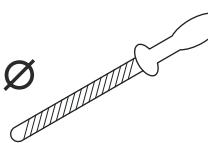
Δεν είναι εύκολο να ακονίσετε μια αλυσίδα πριονιού σωστά χωρίς το σωστό εξοπλισμό. Χρησιμοποιήστε οδηγό ακονίσματος της Husqvarna. Αυτό θα σας βοηθήσει να διατηρήσετε τη μέγιστη απόδοση κοπής και να ελαχιστοποιήσετε τον κίνδυνο κλωτσήματος.
