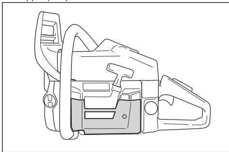
**ΠΡΟΣΟΧΗ:** Αφαιρέστε το χειμερινό κάλυμμα εάν η θερμοκρασία αυξηθεί πάνω από τους 0°C/32°F. Κίνδυνος υπερθέρμανσης και ζημιάς του κινητήρα.
