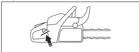
4. Zaženite izdelek in pritisnite polni plin.
