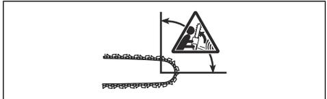
Ein Rückschlag ist immer in Richtung der Führungsschiene gerichtet. Normalerweise wird das Gerät gegen den Bediener geschleudert, manchmal aber auch in eine andere Richtung. Sie beeinflussen
