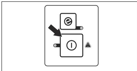
2. Estrarre la batteria e premere i pulsanti per il rilascio della batteria per rimuovere la batteria dal relativo supporto.
