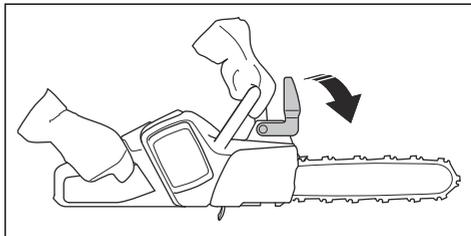
3. Inserire la batteria nel relativo supporto.
