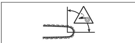
Il contraccolpo avviene sempre lungo il piano di taglio della barra di guida. In genere, il prodotto viene lanciato contro l'operatore, ma può anche spostarsi in un'altra direzione. Il modo in cui si utilizza il prodotto, quando si verifica il contraccolpo, induce la direzione del movimento.
