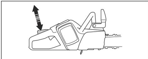
3. Assicurarsi che la leva di comando sia bloccata sul minimo quando viene rilasciato il fermo della leva di comando.
