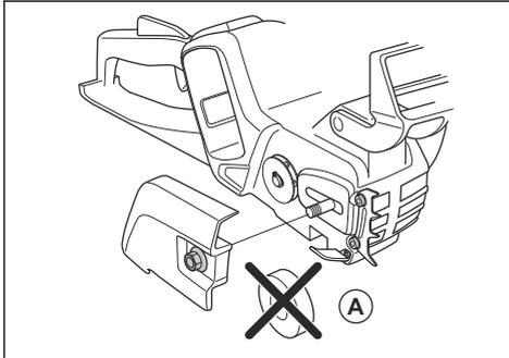
3. Posizionare la barra di guida sopra il bullone della barra. Portare la barra guida nella sua posizione più arretrata. Sollevare la catena sopra il pignone guida e inserirla nella scanalatura sulla barra guida. Cominciare dalla parte superiore della barra guida.
