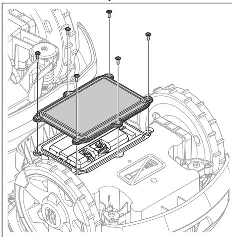
4. Retire los 2 tornillos y retire la abrazadera.
