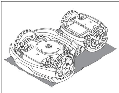
3. Retire los 6 tornillos y la cubierta de la batería.
