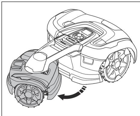
3. Coloque una protección entre la cubierta superior trasera y la barra de tracción. La finalidad de hacerlo es evitar dañar la cubierta superior trasera.
