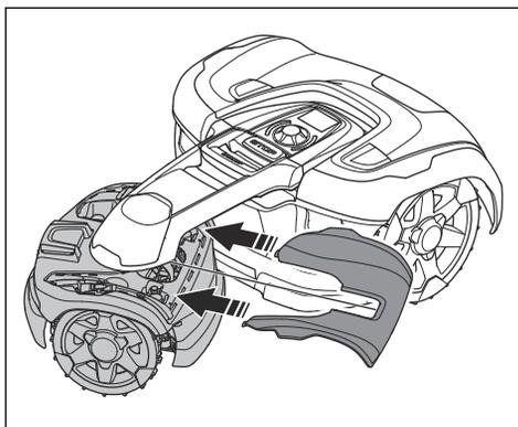
2. Coloque la cubierta superior en la posición correspondiente (A) y empuje los 2 imanes para montar la cubierta superior (B).
