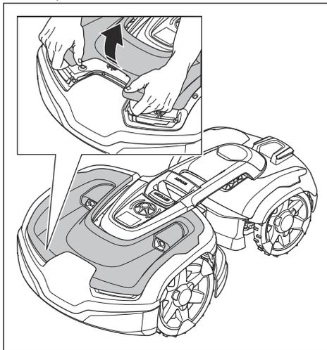
3. Levante la cubierta superior delantera.
