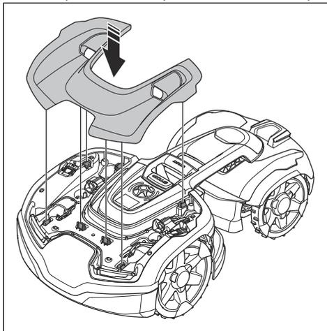
2. Empuje la cubierta superior delantera hasta que quede colocada en la posición correspondiente.
