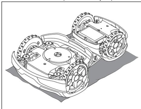
4. Gire la placa protectora hasta que sus orificios estén alineados con los tornillos de la cuchilla.
