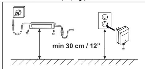
5. Conecte el cable de la fuente de alimentación a una toma de corriente de 100-240 V.
