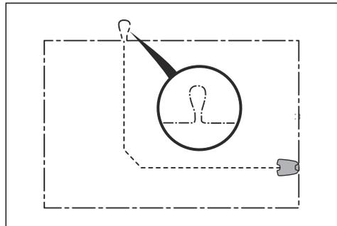
**Nota:** Elabore un plano del área de trabajo antes de instalar el cable delimitador y el cable guía.
