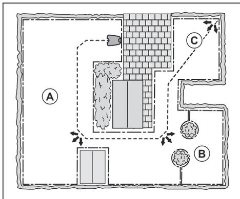
Cada área puede activarse o desactivarse. Utilice la función *Prueba* para medir la distancia desde la estación de carga hasta donde el producto debe comenzar a cortar el césped.
