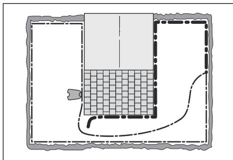
Continúe hasta que solo quede una sección muy corta del cable, que será la diferencia ente una luz verde fija y una luz azul intermitente. Después, siga las instrucciones del paso 5 a continuación.
