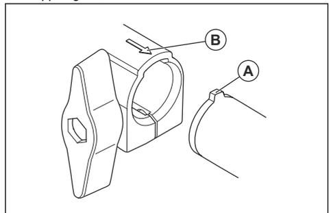
3. Drücken Sie das Führungsrohr in die Kupplung bis zum Einrasten in seine Position.
