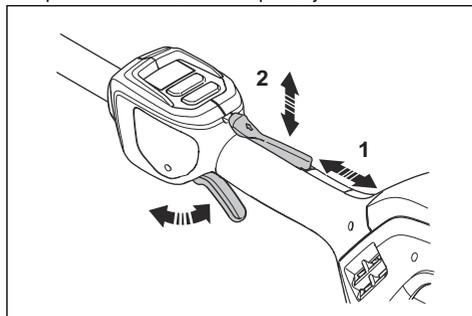
3. Sprožilnik plina in zaklep sprožilnika plina se morata prosto premikati in povratna vzmet mora delovati pravilno.
