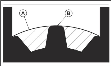
5. Wenn der Schmierfettstand zu niedrig ist, füllen Sie das Winkelgetriebe mit Husqvarna Schmierfett für Winkelgetriebe. Füllen Sie es langsam ein, und drehen Sie die Antriebswelle dabei. Stoppen Sie beim korrekten Füllstand (B).
