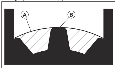
5. Če je raven masti prenizka, poševni prenos napolnite Husqvarna z masljo za kotne prenose. Počasi napolnite in obrnite pogonsko gred, ko nanašate mast za kotne prenose, ustavite na ustrezni ravni (B).
