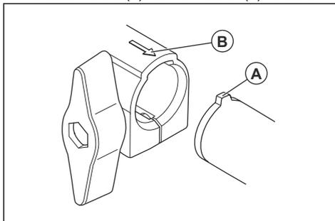
3. Laita runkoputki liitäntään niin, että se napsahtaa paikalleen.
