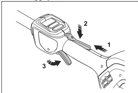
1. Kontroller at kraftutløseren er låst når kraftutløserperren står i utgangsstillingen.
