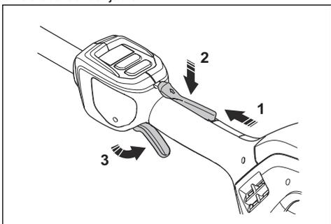
1. Se till att gasreglaget är låst när gasreglagespärren är i sitt ursprungliga läge.
