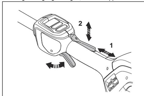
3. Kontrollér, at strømudløseren og låsen bevæger sig frit, og at returfjederen fungerer korrekt.
