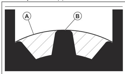
5. Hvis fedtstanden er for lav, skal du fylde vinkelgearet med Husqvarna fedt til vinkelgear. Fyld langsomt, og drej drivakslen, mens du påfører vinkelgearet fedt. Stop ved det korrekte niveau (B).
