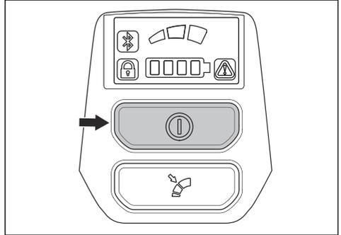
3. Tryck på frigöringsknapparna på batteriet och dra ut batteriet.
