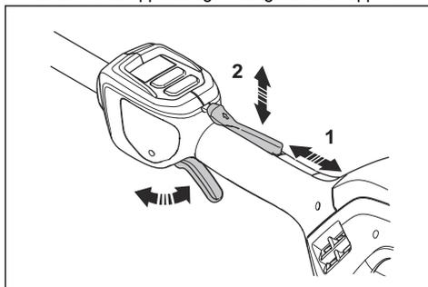
3. Kontroller at kraftutløseren og kraftutløserperren kan bevege seg fritt og at returfjæren fungerer som den skal.
