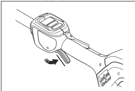
2. Tryck in gasreglaget och kontrollera att det återgår till sitt ursprungsläge när det släpps.
