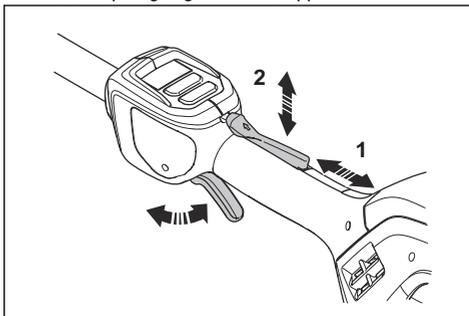
3. Kontrollera att gasreglaget och gasreglagespärren rör sig fritt och att deras retur fjädersystem fungerar.
