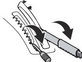
5. Opuścić dźwignię położenia serwisowego świdra, aby unieść świdra do położenia serwisowego.
