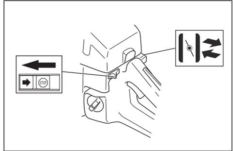
4. Drücken Sie das Dekompressionsventil (A).
