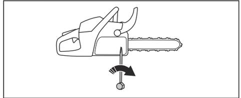
5. Ziehen Sie die Muttern der Führungsschiene mit dem Zoll-Schraubenschlüssel an, und heben Sie gleichzeitig die Vorderseite der Führungsschiene an.
