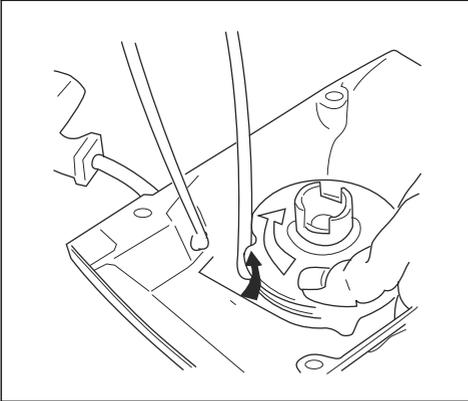
5. Entfernen Sie die mittlere Schraube und die Riemenscheibe.
