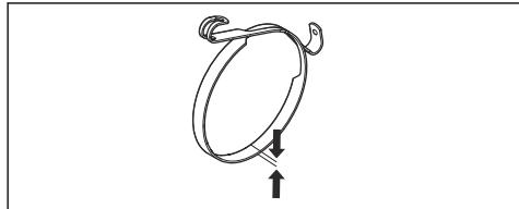
2. Proverite traku kočnice. Traka kočnice mora da bude debela bar 0,6 mm / 0,024 inča na najtanjem mestu.
