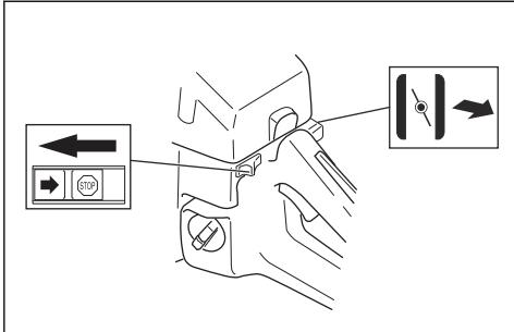
4. Pritisnite dekompresioni ventil (A).
