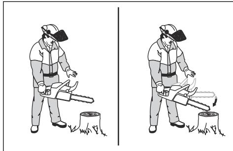
5. Uverite se da se kočnica lanca aktivira dok vrh vodilice udara o panj.
