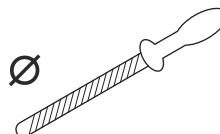
Lanac testere se teško pravilno oštiri ako nemate odgovarajuću opremu. Koristite Husqvarna turpiju za oštrenje. Ovako obezbeđujete maksimalne radne karakteristike pri rezanju i smanjujete opasnost od povratnog udara na minimum.
