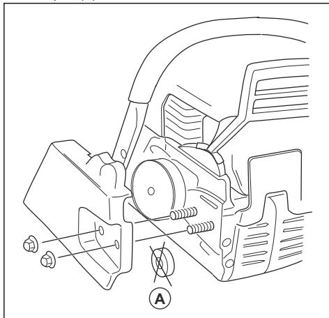
**Napomena:** Ako se poklopac kvačila teško skida, pritegnite navrtku vodilice, pa aktivirajte i pustite kočnicu lanca. Pri pravilnom otpuštanju se čuje klik.
