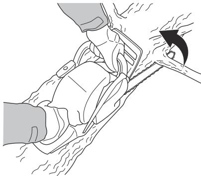
**UPOZORENJE:** Zaustavite motor ako se lanac uštine u deblu. Pomoću poluge otvorite zasek i uklonite proizvod. Nemojte pokušavati da izvučete proizvod rukom. To može rezultirati telesnom povredom kada se proizvod naglo oslobodi.
