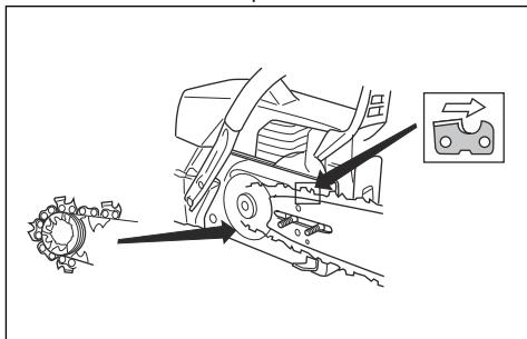
6. Poravnajte otvor na vodilici sa iglicom za podešavanje vodilice i postavite poklopac kvačila.
