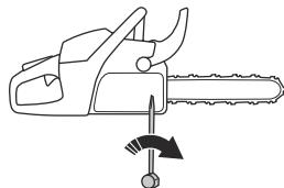
5. Pritežite navrtke vodilice ključem i istovremeno podignite vrh vodilice.
