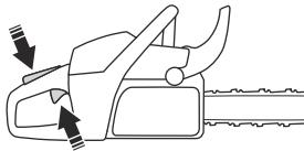
8. Pociągnąć dźwignię hamulca do tyłu, aby zwolnić hamulec łańcucha.
