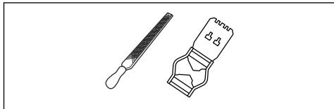
1. Χρησιμοποιήστε μια επιπέδη λίμα και ένα όργανο μέτρησης βάθους για να προσαρμόσετε τη ρύθμιση του μετρητή βάθους. Χρησιμοποιήστε μόνο το όργανο μέτρησης βάθους της Husqvarna για να επιτύχετε τη σωστή ρύθμιση του μετρητή βάθους και τη σωστή γωνία για το μετρητή βάθους.
