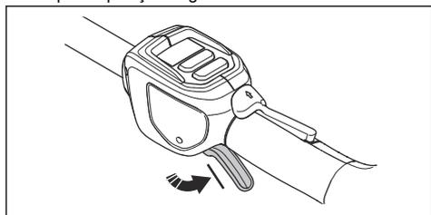
2. Pressione o bloqueio do interruptor de alimentação para a frente (A) e para baixo. Mantenha o bloqueio do interruptor de alimentação contra o punho (B) e certifique-se de que este regressa à respetiva posição original quando o soltar.
