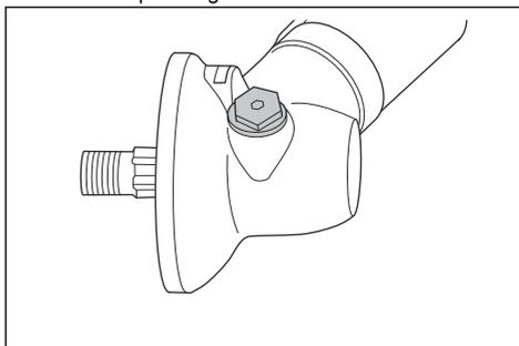
4. Mire dentro del orificio del tapón de grasa y gire el eje propulsor. El nivel de grasa (A) debe estar al mismo nivel que la parte superior de los engranajes (B).
