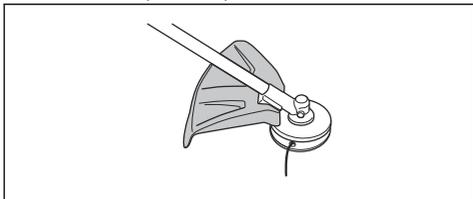
3. Substitua a proteção do equipamento de corte, caso esteja danificada.
