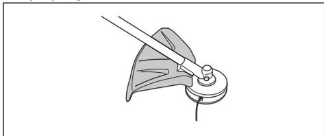
3. Si la protección del equipo de corte está dañada, cámbiela.
