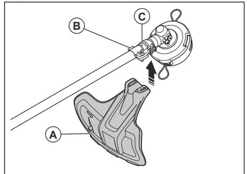
2. Instale la protección del equipo de corte en el eje y aprétela con el perno (C).
