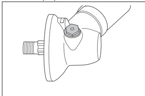
4. Examine através do orifício do tampão para massa lubrificante e rode o eixo motriz. O nível de massa lubrificante (A) tem de estar ao nível da parte superior das engrenagens (B).
