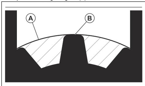
5. Se o nível de massa lubrificante for demasiado baixo, encha a engrenagem cônica com massa lubrificante Husqvarna para engrenagens cônicas. Encha lentamente e rode o eixo motriz à medida que aplica massa lubrificante para engrenagens cônicas; pare quando atingir o nível correto (B).
