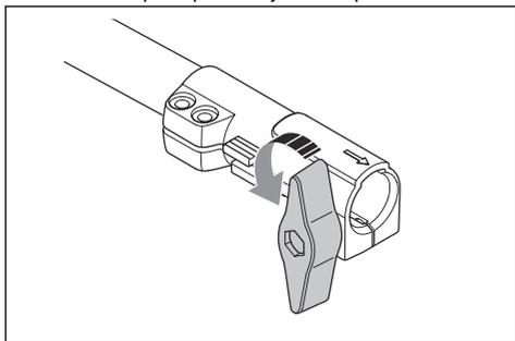
2. Alinee la pestaña (A) con la flecha (B) del acoplamiento.
