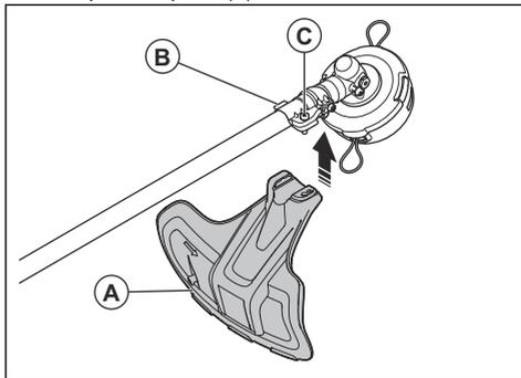
2. Instale a proteção do acessório de corte no eixo e aperte-a com o parafuso (C).
