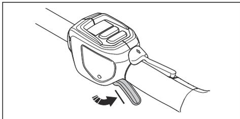
2. Empuje el bloqueo del gatillo de alimentación hacia delante (A) y hacia abajo. Sujete el bloqueo del gatillo de alimentación contra el asa (B) y asegúrese de que vuelva a su posición inicial al soltarlo.
