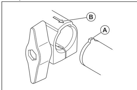
3. Introduzca el tubo en el acoplamiento hasta que encaje en su posición.
