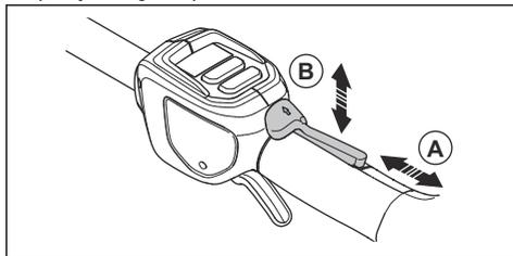
3. Certifique-se de que o interruptor de alimentação e o respetivo bloqueio se deslocam livremente e de que as molas de retorno funcionam corretamente.
