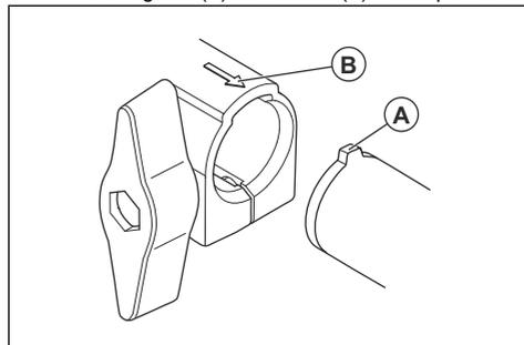
3. Empurre o eixo para o acoplamento até encaixar no devido lugar.
