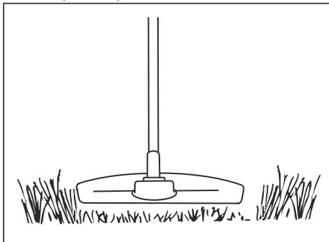
2. No empuje el cabezal de corte contra el suelo. El suelo y el producto pueden resultar dañados.
