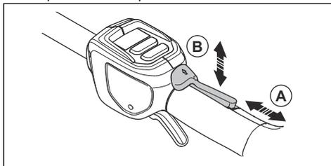
3. Compruebe que el gatillo de alimentación y el bloqueo se mueven con facilidad y que los muelles de retorno funcionan correctamente.
