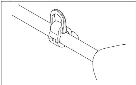
**Nota:** Não coloque o gancho de suspensão sobre o adesivo.
