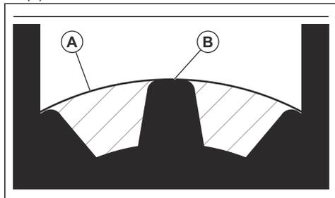
5. Si el nivel de grasa es demasiado bajo, llene el engranaje angulado con grasa para engranajes angulados Husqvarna. Llène lentamente y gire el eje propulsor mientras aplica la grasa para engranajes angulados; pare en el nivel correcto (B).
