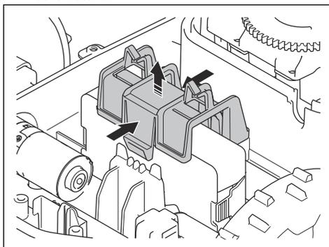
8. Desconecte el cable de la batería del circuito impreso principal.
