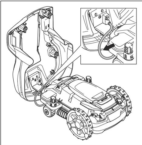
**Nota:** Asegúrese de que los pasacables del cable de carga están bien instalados para impedir la entrada de humedad tras retirar la carcasa del producto.
