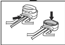
Si la luz indicadora ahora es verde, la rotura está en algún lugar del cable entre el extremo desconectado y el punto donde se conecta el cable nuevo (la siguiente línea negra y gruesa). En ese caso, acerque la conexión del cable nuevo a la punta desconectada (más o menos, en la mitad de la sección del cable que podría estar dañada) y vuelva a comprobar si la luz indicadora está en verde.
