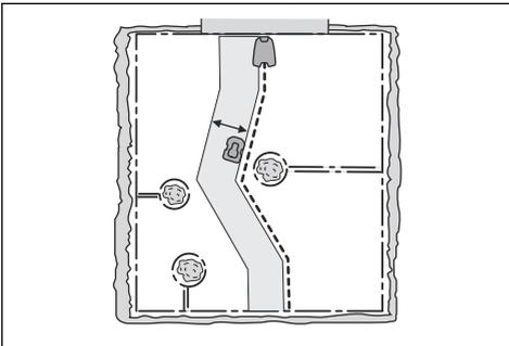
El ancho del pasillo se ajusta automáticamente. Si es necesario ajustar el ancho del pasillo manualmente para que el producto funcione correctamente, puede establecerlo entre 0-9. Si el ancho del pasillo guía está ajustado en 0, el producto sigue el cable guía. El ajuste
