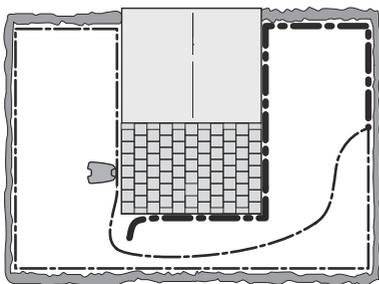
Continúe hasta que solo quede una sección muy corta del cable, que será la diferencia entre una luz verde fija y una luz azul intermitente. Después, siga las instrucciones del paso 5 a continuación.
