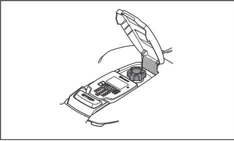
3. Gire el mando de ajuste de altura de corte para seleccionar la altura de corte.
