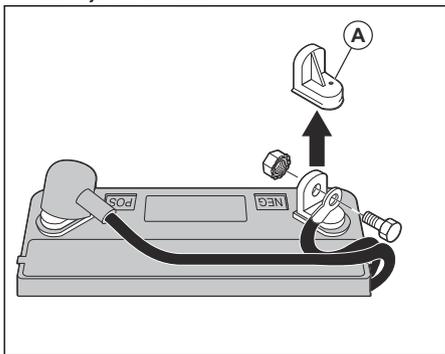
4. Pievienojiet sarkano akumulatora kabeli pie pozitīvā pola (+) spaiļes un nostipriniet skrūvi un uzgriezni, kā parādīts attēlā. Uzlieciet spaiļi pārsegu.
