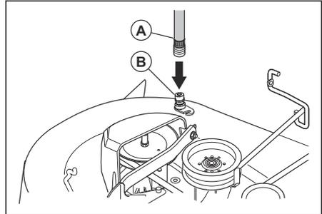
7. Pavelciet atpakaļ sprauslas adaptera fiksējošo gredzenu un uzspiediet sprauslas adapteri uz pamatnes skalošanas pieslēģvietas (B).
