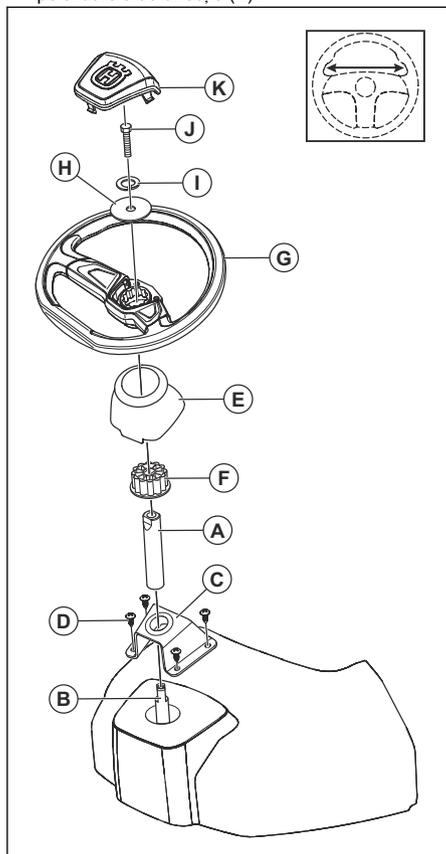
2. Puneți consola de direcție superioară (C) pe extensia arborelui de direcție până când este lipită de panoul de bord.
