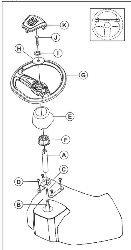
2. Установите верхний кронштейн рулевого управления (C) на удлинитель вала рулевого управления так, чтобы он плотно прилегал к приборной панели.
