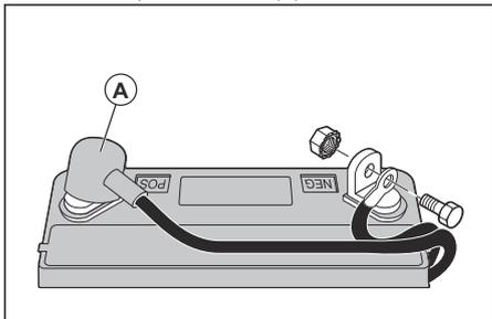
4. Отверните болт и гайку, чтобы отсоединить черный (отрицательный) провод аккумулятора от отрицательной (-) клеммы.
