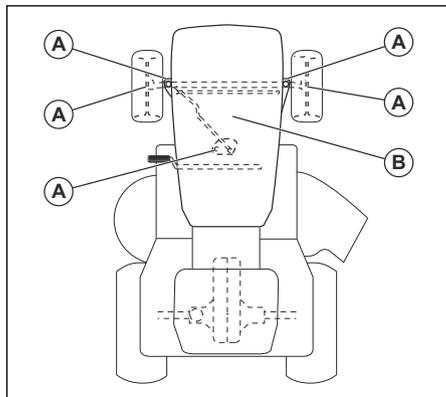
A. Общо смазване Смажете връзката за гресиране на шпиндела, лагера на предното колело и зъбите на кормилната част.
