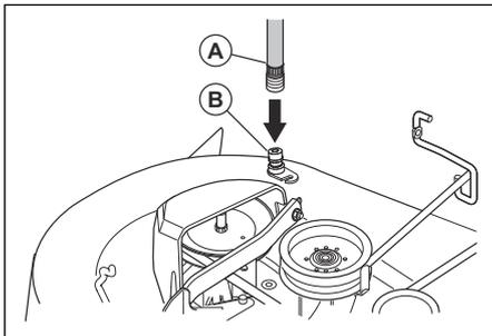
7. Оттяните зажимное кольцо переходника для сопла, чтобы подсоединить переходник для сопла к промывочному патрубку (В).
