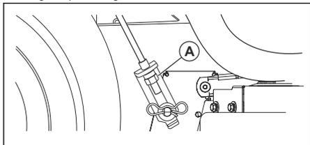
**Piezīme:** Katrs pilns regulēšanas uzgriežņa apgrieziena maina pļaušanas bloka augstumu par aptuveni 3/16 collām (4,7 mm).
