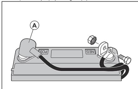
4. Noņemiet skrūvi un uzgriezni, lai atvienotu melno (negatīvo) akumulatora kabeli no negatīvās (-) spaiļes.
