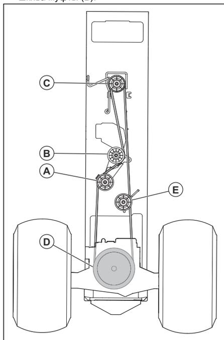
4. Снимите приводной ремень со шкива двигателя (С) на валу двигателя.
