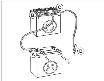
2. Подключите другой конец красного кабеля аккумулятора к ПОЛОЖИТЕЛЬНОЙ (+) клемме (В) заряженного аккумулятора.
