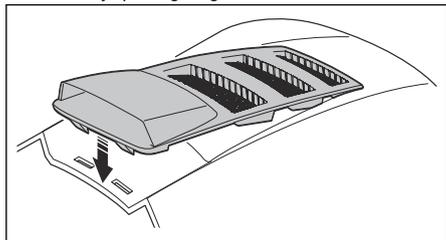
3. Iespiediet motora pārsega uzliku uz motora pārsega.
