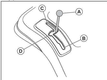
4. Deplasați maneta de control al mișcării suplimentar înainte sau înapoi pentru a mări viteza.
