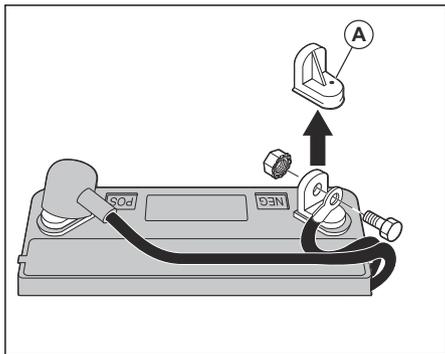
4. Подсоедините красный провод аккумулятора к положительной (+) клемме и затяните болт с гайкой, как показано на рисунке. Переместите крышку клеммы на клемму.
