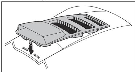
3. Натиснете надолу покривния елемент на капака на двигателя върху капака на двигателя.
