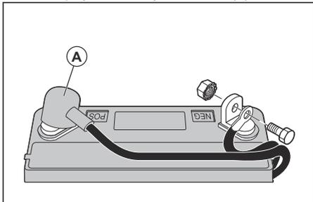
4. Scoateți șurubul și piulița pentru a deconecta cablul negru (negativ) al bateriei de la borna negativă (-).
