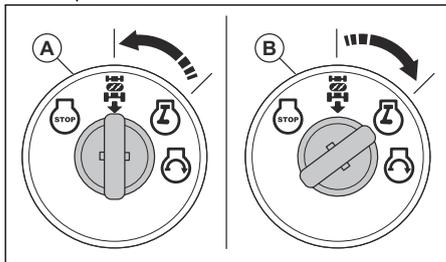
2. Чтобы включить систему ROS, поверните ключ зажигания против часовой стрелки в положение включения системы ROS (A).
