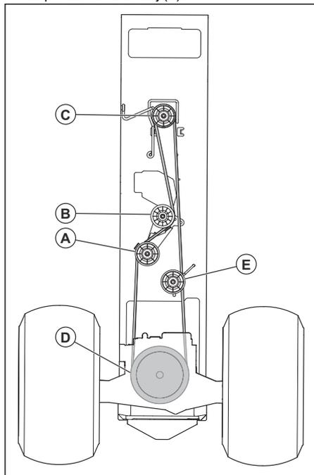
4. Scoateți cureaua de transmisie de pe fulia motorului (C) de pe arborele motor.
