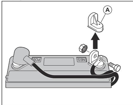
4. Conectați cablul roșu al bateriei la borna pozitivă (+) și strângeți șurubul și piulița conform imaginii. Glisați apărătoarea pentru bornă peste aceasta.
