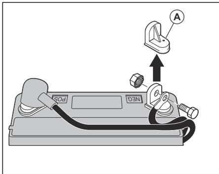
4. Ühendage punane akukaabel plussklemmiga (+) ning keerake polt ja mutter kinni joonisel kujutatud viisil. Liigutage klemmikate klemmle.
