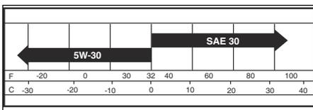
**Примечание:** Мультивязкостные масла (5W30, 10W30 и т.д.) упрощают запуск двигателя в холодную погоду, однако работа при температуре выше 0 °C / 32 °F может привести к повышенному расходу масла. Регулярно проверяйте уровень моторного масла, чтобы предотвратить возможное повреждение двигателя из-за работы при низком уровне масла.
