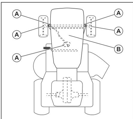
A. Ungerea generală. Lubrifiați conexiunea de ungere a pivotului, rulmentul roții din față, dantura pinioanelor coloanei de direcție.
