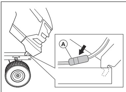
1. Поднимите кожух двигателя.
