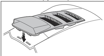
3. Apăsăți în jos piesa de pe capacul motorului pe capacul motorului.
