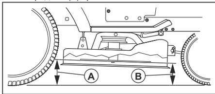
**Примечание:** Для получения оптимальных результатов кошения ножи должны быть отрегулированы таким образом, чтобы в крайнем верхнем положении передняя кромка была на 3,1-12,7 мм (1/8-1/2 дюйма) ниже задней.
