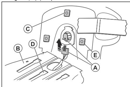
4. Amplașați scaunul pe suportul pentru scaun (B) și așezați piesa mediană de plastic (C) în orificiul de asamblare al fantei din mijloc (D).
