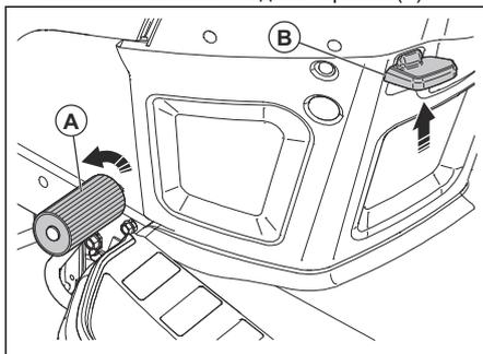
2. При нажатой педали тормоза потяните вверх рычаг стояночного тормоза (B).
