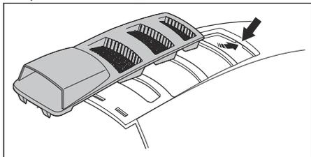
2. Подравнете задните палци на покривния елемент на капака на двигателя с прорезите в капака на двигателя.
