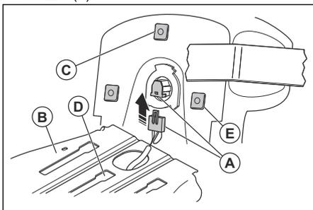
4. Novietojiet sēdekli uz sēdekļa pamatnes (B) un ievietojiet vidējo plastmasas gabalu (C) vidējā slotā montāžas atverē (D).
