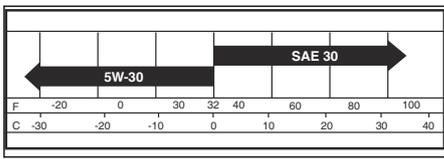
**Nota:** Uleiurile multigrad (5W30, 10W30 etc.) contribuie la o pornire mai ușoară a motorului în sezonul rece, dar duc la un grad crescut de utilizare a uleiului atunci când sunt utilizate la temperaturi de peste 32 °F / 0 °C. Verificați nivelul uleiului mai des, pentru a evita posibila defectare a motorului provocată de nivelul scăzut al uleiului.
