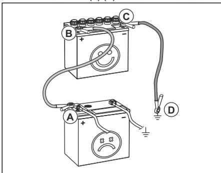
2. Conectați celălalt capăt al cablului roșu al bateriei la borna POZITIVĂ (+) (B) a bateriei încărcate.
