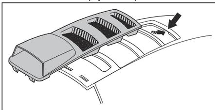
2. Aliniați umerii posteriori ai piesei de pe capacul motorului cu decupajele din capacul motorului.
