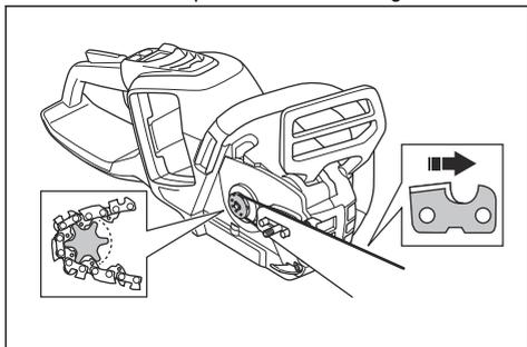
5. Montare il coperchio del pignone guida e inserire il fermo tendicatena nel foro sulla barra di guida.
