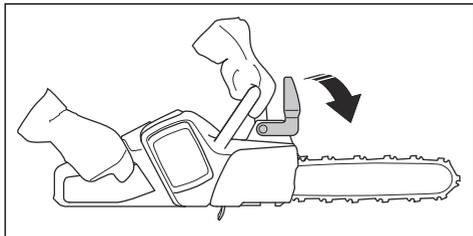
3. Inserire la batteria nel relativo supporto.
