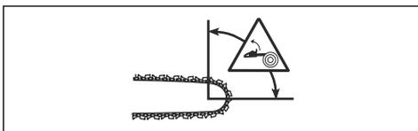
Il freno della catena (A) si attiva manualmente con la mano sinistra o in automatico con il meccanismo di attivazione inerziale. Spingere la protezione anticuntraccolpo (B) per inserire manualmente il freno della catena. Questo movimento attiva un meccanismo caricato a molla che blocca il pignone guida.
