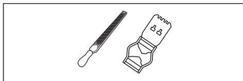
1. Utilizzare una lima piatta e uno strumento di misurazione del calibro di profondità per questa impostazione. Utilizzare esclusivamente il nostro strumento di misurazione del calibro di profondità per avere profondità e angolo corretti.
