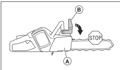
Il modo in cui il freno della catena viene innestato è correlato alla forza del contraccolpo e alla posizione del prodotto. In caso di intenso contraccolpo mentre il relativo settore è quello più lontano dall'operatore, il freno della catena viene innestato dal meccanismo inerziale. Se il contraccolpo è leggero e il settore di contraccolpo è più vicino all'operatore, il freno della
