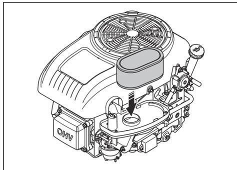
7. エアフィルターカバーを取り付けてノブを締め込みます。
