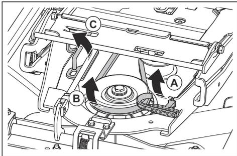
4. 左手でスプリングハンドルを持ち、右手でドライブベルトを取り外します。
