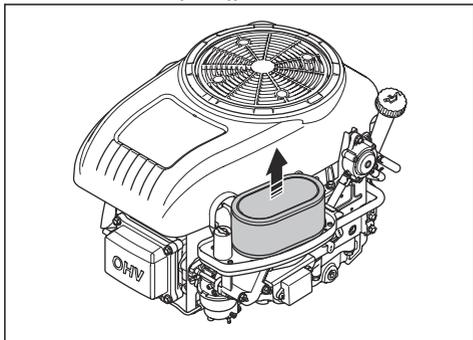
4. Trintelėkite popierinį filtrą į kietą paviršių, kad jį išvalytumėte. Nenaudokite suspausto oro.
