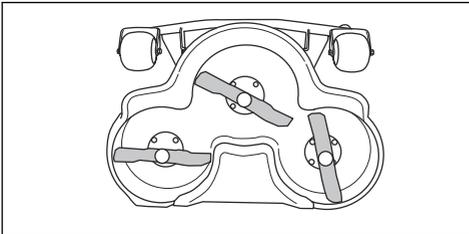
3. 45-50 Nm の締め付トルクでブレードボルトを締め付けます。
