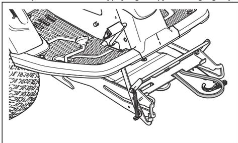
6. Nuleiskite įrangos rėmą. Pakelkite techninės priežiūros padėties fiksavimo įtaisą į vertikalią padėtį.
