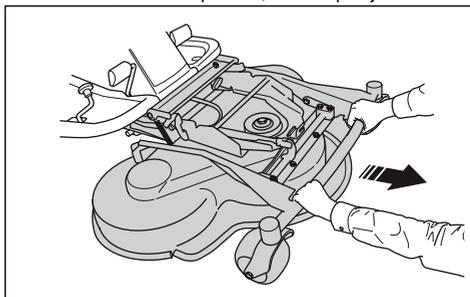
3. Celiet pļaušanas bloku vertikālai pozīcijai, kamēr atskan klikšķis. Pļaušanas bloks tiek automātiski bloķēts vertikālā pozīcijā.
