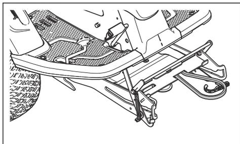
6. Vajutage varustuse raam alla. Tõstke hoolduslukk vertikaalasendisse.
