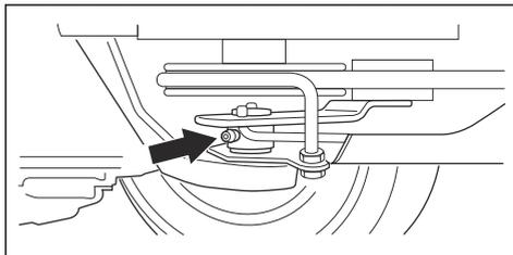
3. ベルトシールドを取り付けて2本のネジを締め込みます。
