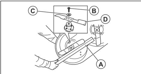
3. ブレードのボルト (B) を緩めて、ブレードボルト、ワッシャー (C)、およびブレード (D) を取り外します。
