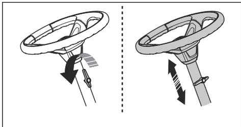
2. ステアリングホイールの高さを調整します。
