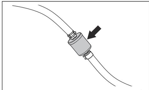
5. ホースの端に新しい燃料フィルターを押し入れます。燃料フィルターの両端に液体洗剤を塗布して、接続しやすくします。
