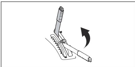
カッティングデッキを芝刈位置に降ろすには、ロックボタンを押して、リフトレバーを前方に移動します。エンジンを運転している場合は、ブレードが自動的に回転を始めます。
