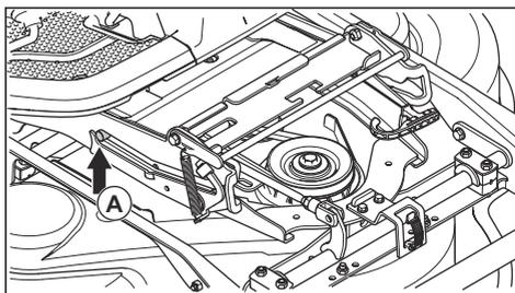
8. Paceliet pļaušanas augstuma enkuru no enkura turētāja un ievietojiet to pļaušanas augstuma enkura atverē (A).
