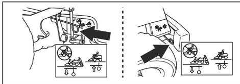
2. Tõstke lõikeosa üles ja rakendage seisupidur.
