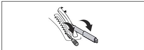
5. Tõmmake joonise eeskujul veorihma ja veenduge, et see ei jääks kinni ega puruneks, kui lõikeosa on kinnitatud.
