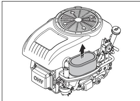
4. 表面が硬い物に紙フィルターを打ち当ててフィルター清掃します。圧縮空気を使用しないでください。
