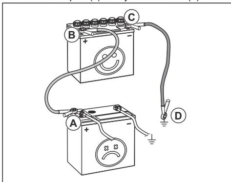
4. Otru sarkanā vada galu pievienojiet pie POZITĪVĀ akumulatora pola (+) uz pilnībā uzlādētā akumulatora (B).
