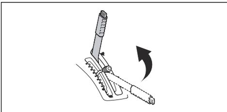
Lai nolaištu plaušanas bloku plaušanas pozīcijā, nospiediet bloķēšanas pogu un pabīdīet pacelšanas sviru uz priekšu. Ja motors ir ieslēgts, asmeņi automātiski sāk rotēt.
