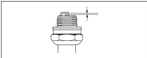
6. 電極の側面を曲げて電極間隔を調整します。
