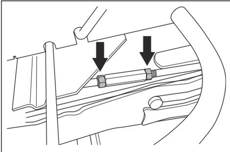
4. リフト支柱を回してステイを伸ばすか縮めます。ステイを伸ばすと、カバーの後端が上がります。ステイを縮めると、カバーの後端が下がります。
