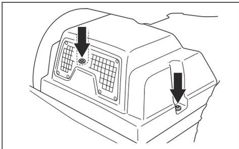
2. トランスミッション用オイルタンクの油面が、タンク上の2本の水平線の間にあるかを確認します。
