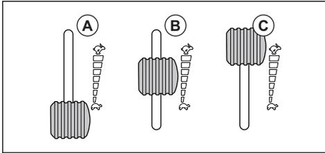
**注記：** エンジンが最高速度の状態ではブレードをかみ合わせると、ドライブベルトに負担がかかります。カッティングデッキを芝刈り位置に下ろすまで、フルスロットルにしないでください。
