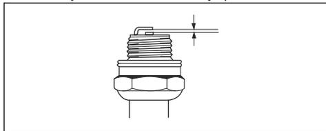
6. Norėdami koreguoti tarpą tarp elektrodų, lenkite išorinį elektrodą.
