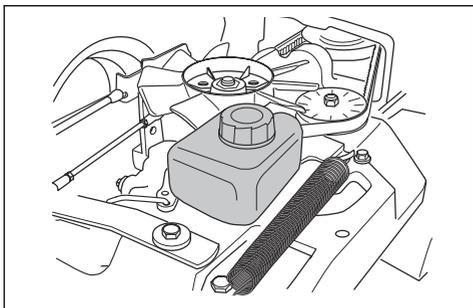
3. 油面が下側の線より下の場合は、エンジンオイルを補充しますが、上側の線を越えないように注ぎます。
