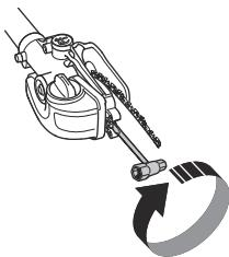
6. A corrente está correctamente esticada quando não mais estiver frouxa na parte inferior da lâmina e ainda possa ser girada facilmente com a mão. Aperte bem as porcas da lâmina com a chave universal ao mesmo tempo que segura a extremidade da lâmina.
