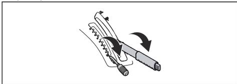
5. Spustením páky servisnej polohy závitovky zdvihnite závitovku do servisnej polohy.
