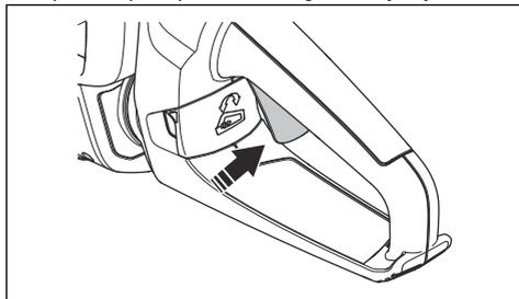
4. Sprostite sprožilec plina in se prepričajte, da povratna vzmet deluje pravilno. Rezilo se mora zaustaviti v manj kot 1 sekundi.
