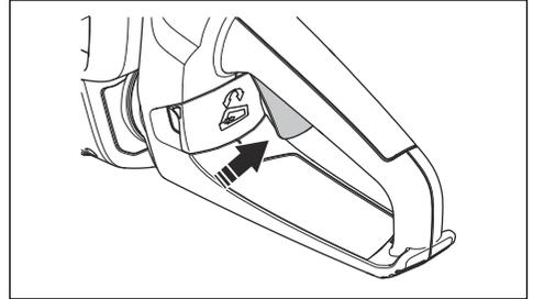
4. Lassen Sie den Gashebel los und stellen Sie sicher, dass die Rückzugfeder ordnungsgemäß funktioniert. Die Klinge muss in weniger als 1 Sekunde anhalten.
