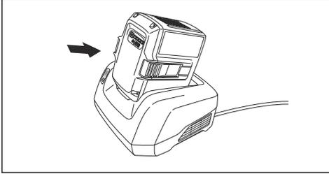
3. バッテリー充電器の緑の充電ライトが点灯していることを確認してください。これにより、バッテリーがバッテリー充電器に正しく接続されていることがわかります。
