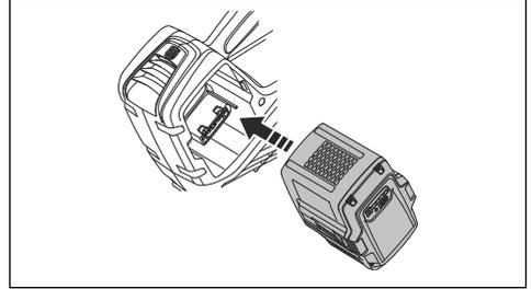
3. バッテリーの下部を押して、バッテリー収納部にはまるまで押し込みます。バッテリーがロックされると、カチッという音がします。
