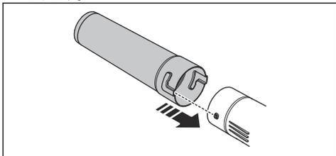
2. ブローノズルを完全に押し込み、ブローノズルを回して製品に固定します。
