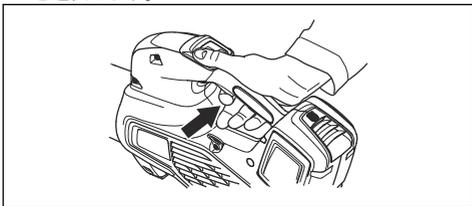
2. クルーズコントロールボタンを押して、選択したエアフローを設定します (LED が点灯します)。
