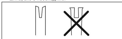
5. Проверете дали върхът на направляващата шина е неравен или много износен.
