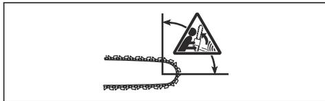
Откатът винаги възниква в режещата равнина на направляващата шина. Обикновено продуктът се изтласква към оператора, но може да се премести и в друга посока. Начинът, по който използвате продукта при възникване на откат, определя посоката на движение.
