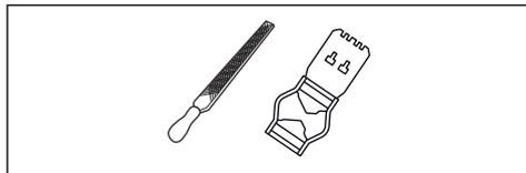
1. Използвайте плоска пила и инструмент за измерване на дълбочина, за да регулирате настройката на мащаба на дълбочината. Използвайте само инструмент за измерване на дълбочина на Husqvarna, за да получите правилната настройка на мащаба на дълбочина и скосяването за мащаба на дълбочина.
