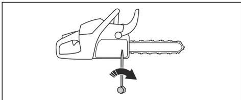
5. Затегнете гайките на шината с гаечния ключ и същевременно повдигнете предната част на направляващата шина.
