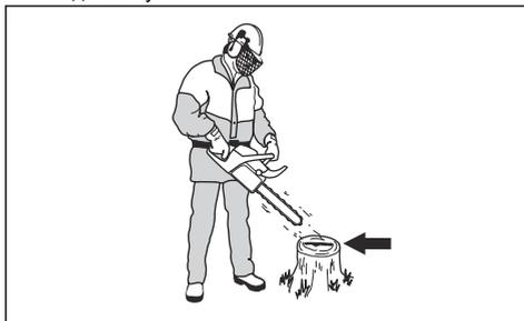
3. Ако смазването на веригата не функционира нормално, проверете направляващата шина. Инструкции можете да видите в *За проверка на направляващата шина на страница 33*. Ако изпълнените действие от техническото обслужване не помогнат, тогава говорете с дистрибутора по сервизното обслужване.
