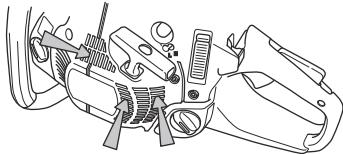
イドプレート、フライホイルの爪、シリンドーの冷却フィン、冷却チャネル、シリンドカバーで構成されています。
