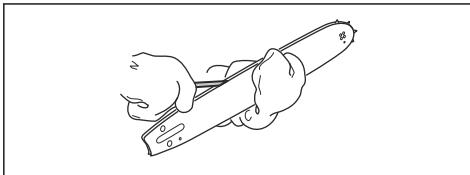
4. ガイドバーの溝に摩耗がないか調べます。摩耗がある場合は、ガイドバーを交換します。
