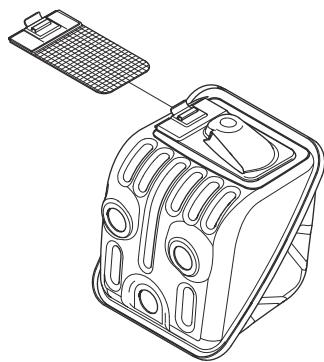
4. 損傷したスパーク防止ネットは交換してください。
