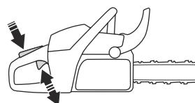
2. スロットルトリガーロックを押し下げて、放すと元の位置に戻ることを確認します。
