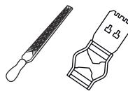
1. 平ヤスリとデブスゲージツールを使用して、デブスゲージ設定を調整します。必ず Husqvarna 推奨のデブスゲージツールを使用して、デブスゲージの設定を正しく行い、デブスゲージの角度を調整してください。
