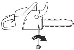
5. レンチを使用してバーナットを締め込みながらガイドバーの前方を持ち上げます。
