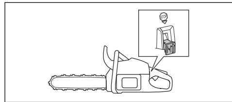
**警告：** スタート/ストップスイッチは自動的に元の位置に戻ります。製品を組み立てたりメンテナンスしたりする際は、誤って始動しないようにするために、スパークプラグからスパークプラグキャップを外します。
