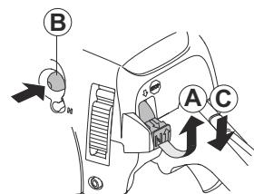
3. エアバージバルブ (B) を約 6 回、または燃料がバルブに注入し始めるまで押します。エアバージバルブを完全に充填する必要はありません。
