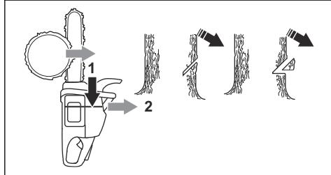
2. 受け口下部が水平で、倒す方向に対して $90^{\circ}$ であることを確認します。
