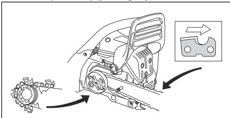
6. Poravnajte otvor u vodilici s iglom za podešavanje lanca i postavite poklopac kvačila.
