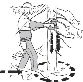
2. Uklonite rastinje u radnom prostoru oko stabla. Uklonite sav odrezani materijal iz radnog prostora.
