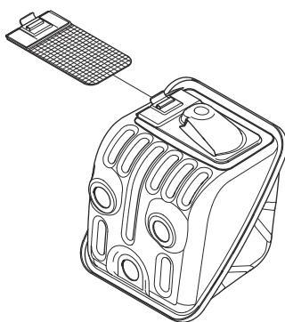
4. Oštećenu mrežicu za odvođenje varnica zamijenite.
