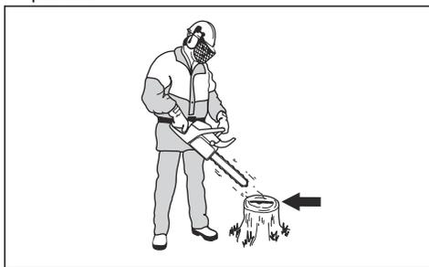
3. Ako podmazivanje lanca motorne pile ne funkcioniše ispravno, provjerite vodilicu. Za upute pročitajte *Provjera vodilice na stranici 31*. Ako mjere održavanja ne pomognu, razgovarajte sa svojim servisnim zastupnikom.
