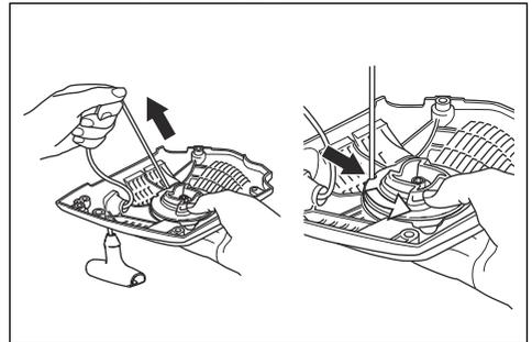
5. Uklonite centralni zavrtnj, pogonski disk (A), oprugu pogonskog diska (B) i remenicu (C).
