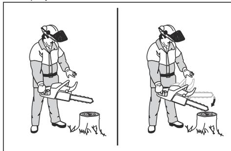
5. Uverite se da se kočnica lanca aktivira dok vrh vodilice udara o panj.
