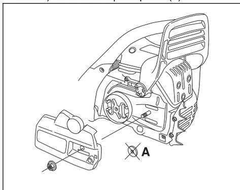
**Napomena:** Ako se poklopac kvačila teško skida, pritegnite navrtku vodilice, pa aktivirajte i pustite kočnicu lanca. Pri pravilnom otpuštanju se čuje klik.
