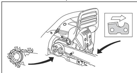
6. Poravnajte otvor na vodilici sa iglicom za podešavanje vodilice i postavite poklopac kvačila.
