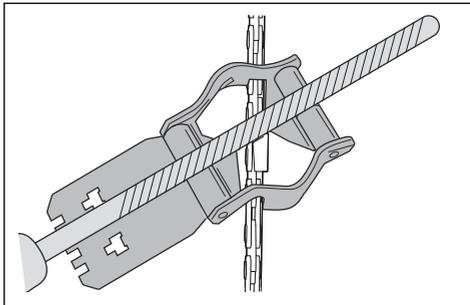
4. Uklonite materijal sa iste strane na svim reznim zubima.
