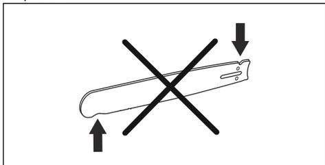
6. Uverite se da se lančanik na vrhu vodilice lako okreće i da otvor za podmazivanje u lančaniku na vrhu vodilice nije zapušen. Po potrebi očistite i podmažite.
