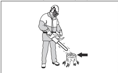
3. Ako podmazivanje lanca ne radi kako bi trebalo, prekontrolišite vodilicu. Uputstva potražite u *Pregled vodilice na stranici 30*. Obratite se serviseru ako procedure za održavanje ne pomognu.
