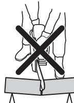
Ako je lanac ukliješten ili je zapeo u području povratnog trzaja, otklonska sila će gurnuti motorni rezac uvis i u kružnom kretanju ga vratiti natrag prema operateru, izazivajući teške ili čak smrtonosne povrede. Pazite na potencijalno pomjeranja komada s kojim se radi. Budite oprezni i pripazite na pomicanje materijala ili bilo kakve druge događaje koje mogu izazvati stezanje reza i zaglavljivanje rezne opreme.
