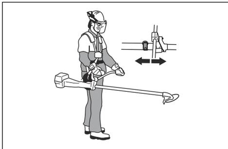
Za čišćenje trave proizvod je pravilno uravnotežen kada je nož na visini rezanja iznad tla.
