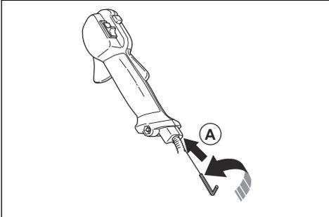
4. Ako je brzina gasa pokretanja previsoka, vijak za podešavanje (A) okrećite u smjeru suprotnom od kazaljke na satu dok se rezni nastavak ne zaustavi. Vijak za podešavanje (A) okrenite u smjeru kretanja kazaljke na satu za dodatnih 1/2 okreta.
