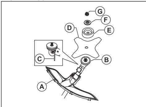
6. Uvjerite se da su pogonski disk i potporna prirubnica pravilno postavljeni na središnji otvor na nožu za travu.
