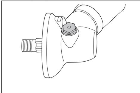
4. Pogledajte u otvor poklopca maziva i okrenite pogonsku osovinu. Razina maziva (A) mora biti u razini s gornjim dijelom zupčanika (B).
