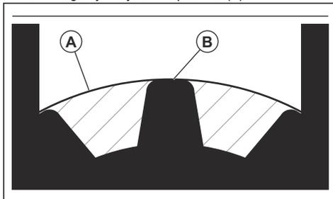
5. Ako je razina maziva preniska, napunite pužni zglob Husqvarna mazivom za pužni zglob. Polako dolijevajte i okrećite pogonsku osovinu dok primjenjujete mazivo za pužni zglob te se zaustavite kad vidite da je mazivo doseglo pravilnu razinu (B).
