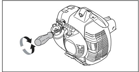
2. Vijak za podešavanje broja okretaja u praznom hodu okrećite u smjeru suprotnom od kazaljke na satu sve dok se rezna oprema ne zaustavi.
