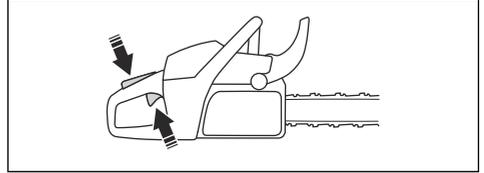
8. 将前护手向后移动可分离链制制动器。
