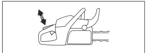
3. 确保在松开油门扳机锁后油门扳机锁止在怠速位置。
