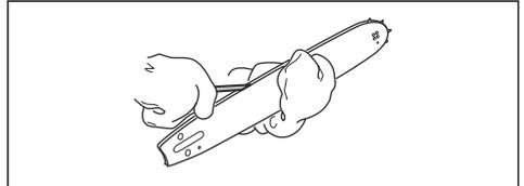
4. 检查导板槽是否磨损。必要时请更换导板。
