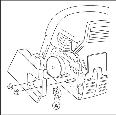
**注意：** 如果离合器罩难以拆下，则拧紧导板螺母，接合链制动器，然后松开。如果正确松开，会听到一声咔哒声。
