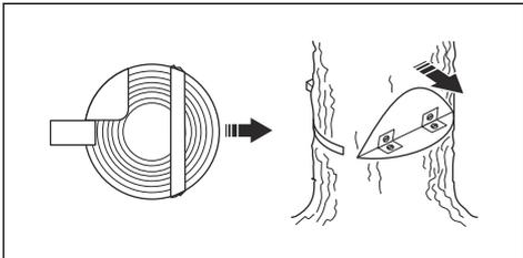
4. 切断安全角，使树木倒落。
