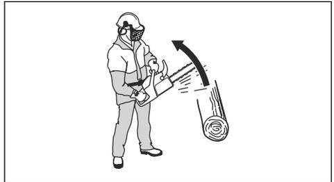
较小的导板端头半径可降低反弹力。
