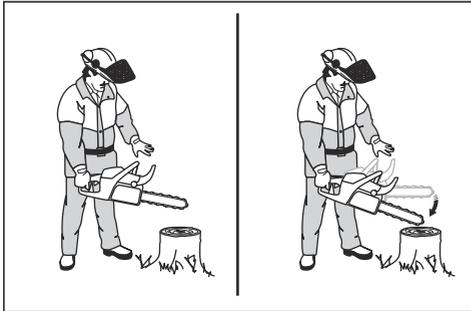
5. 当导板端头碰到树桩时，确保链制动器启动。
