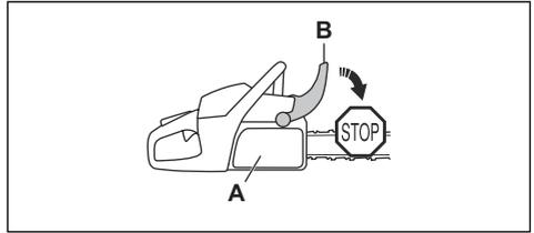
将前护手向后拉动可分离链制动器。
